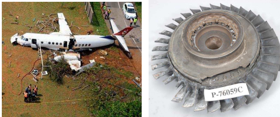
Figure 1.3 Vue du Jetstream et disque endommagé ayant provoqué le crash [Anon 2009]
