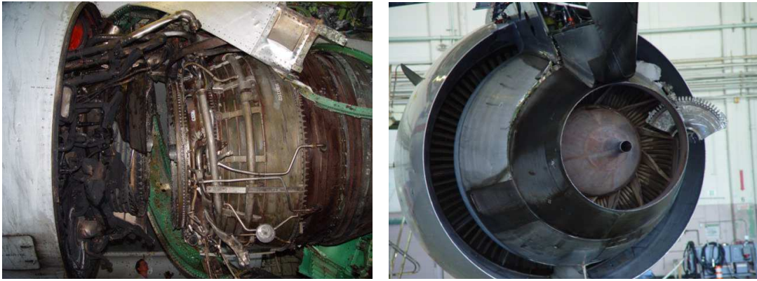
Figure 1.4 Exemple de rupture de disque non contenue lors d'une vérification au sol (Los Angeles, 2006 [Blakey 2006])
