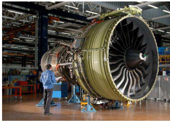
Figure 1.1 Vue du GE90-115B en fin de chaîne d'assemblage (photo Snecma)
