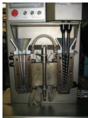
Figure 22 – Microextrudeuse bi-vis permettant d'effectuer la dispersion des MWNT dans le PA11
