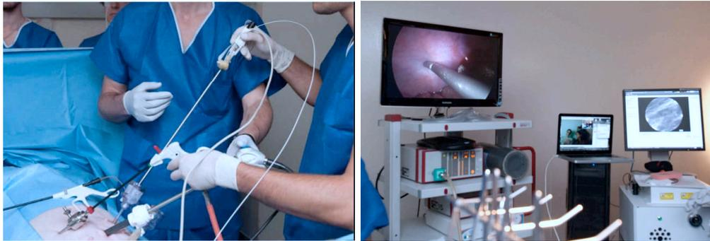
FIGURE 5.25 – Expérimentations *in vivo*. A gauche : prototype de spiraleur inséré dans un trocart de 5 mm. A droite : écrans de visualisation (écran de gauche : vue laparoscopique du spiraleur au contact du péritoine pariétal ; écran de droite : vue Cellvizio).
