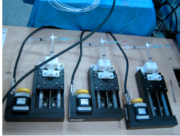
FIGURE 5.10 – Photographie du système de contrôle du volume des ballons utilisant des seringues remplies d'eau fixées sur des platines linéaires.
