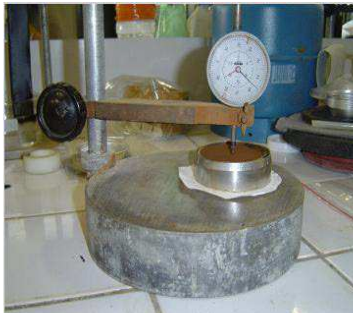
Figure III-19 : Dispositif pour la mesure de la limite de retrait
