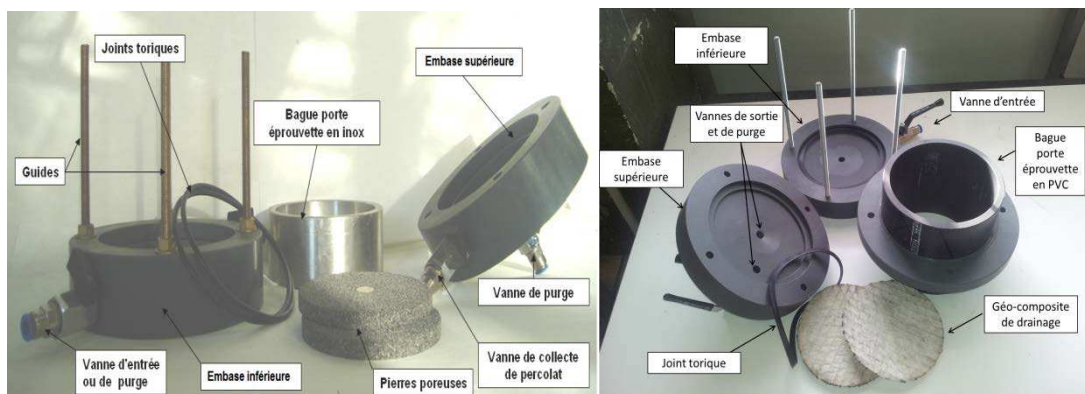
Figure III-33 : Vue éclatée d'un perméamètre à paroi rigide (PPR)
