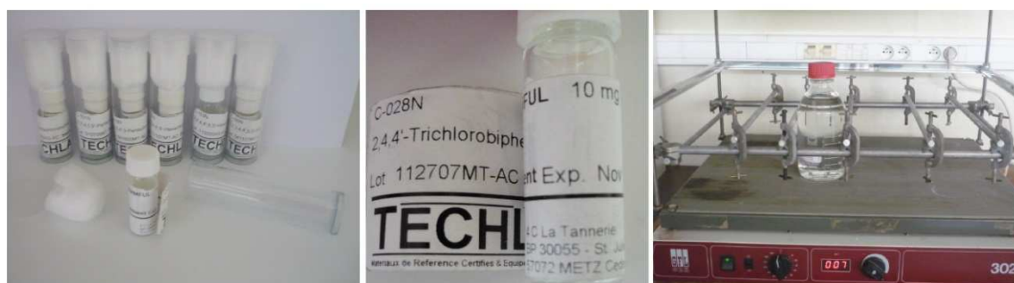
Figure IV-1 : Ampoule de PCB en poudre et agitation horizontale de la solution
