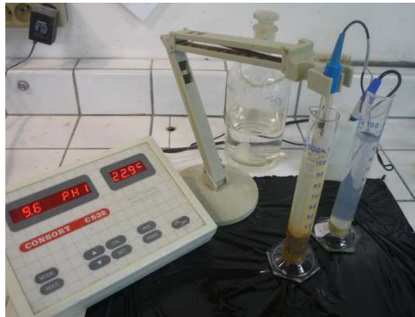
Figure IV-3 : Appareillage pour la mesure de la conductivité électrique et pH
