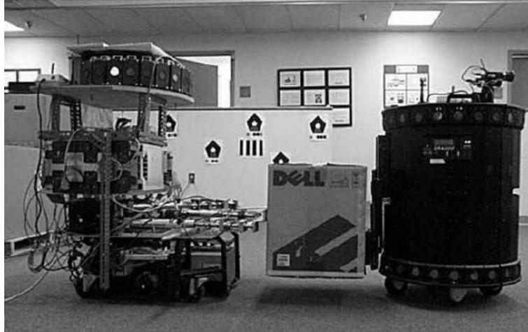
FIGURE 1.9 – Exemple de tâche nécessitant une coordination étroite : transport d’un carton par deux robots [Chaimowicz et al. 2004].
