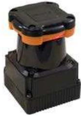
(a) Télémètre laser à balayage
