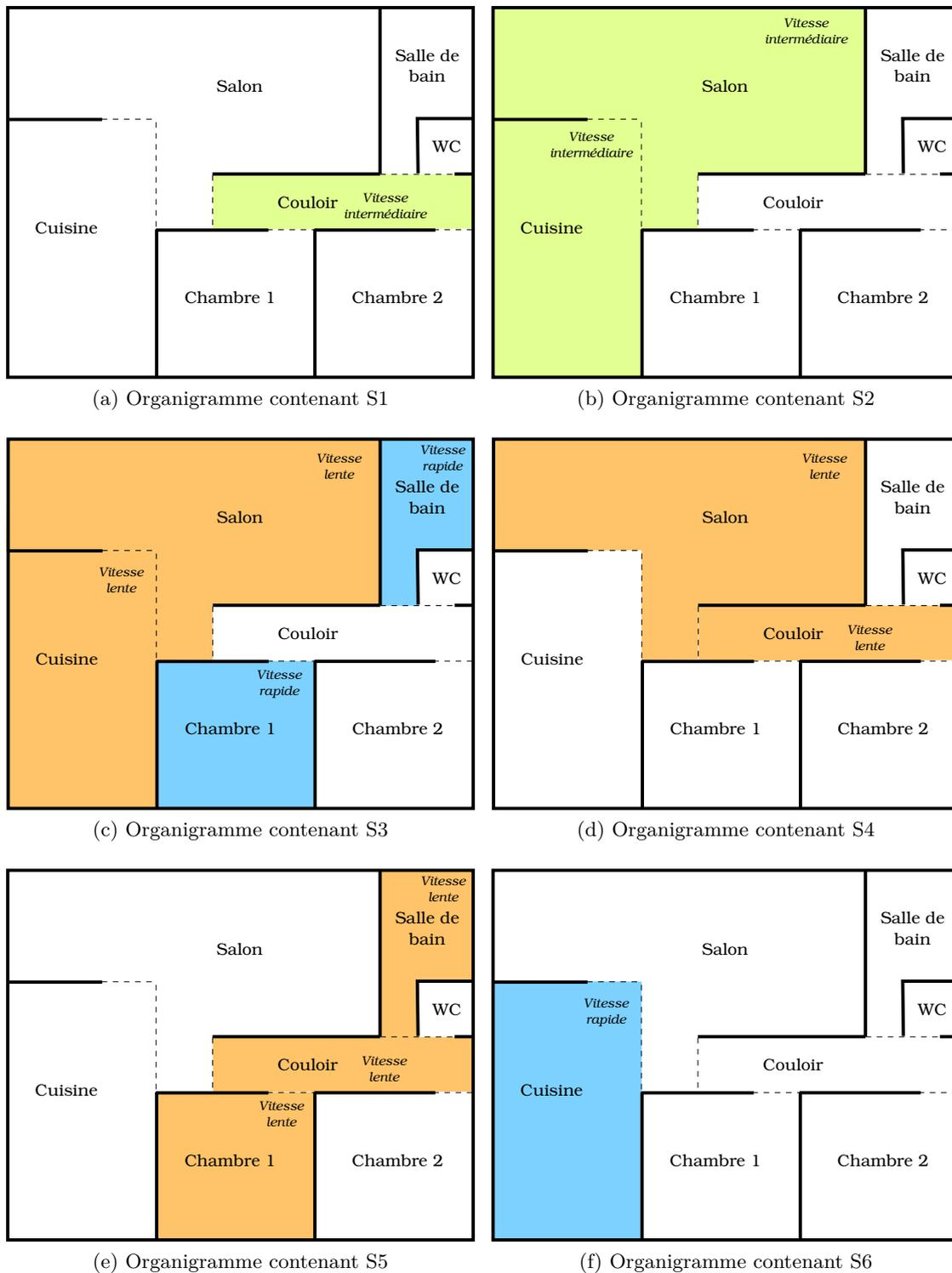
FIGURE 4.9 – Vitesses de déplacement des différents organigrammes faisant appel à des services de positionnement fixes
