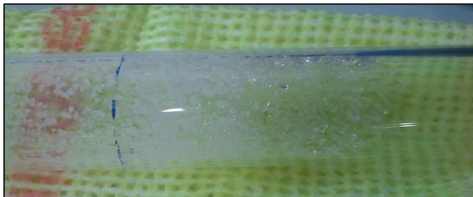
Figure 75 : Précurseur condensé sur le tube en fin de manipulation.
