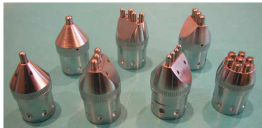
Figure I.29 : Exemple d'indenteurs interchangeables proposés pour l'UltraPeen (Kudryavtsev et al. , 2008).
