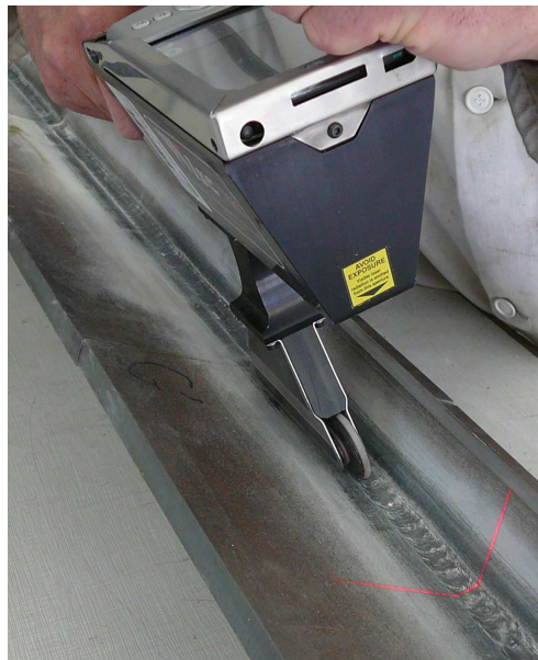
Figure II.2 : Analyse dimensionnelle par triangulation laser (procédé WISC).
