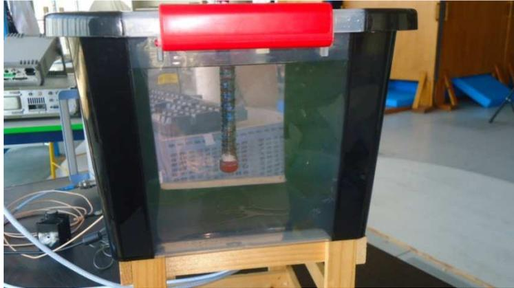
Figure 5.1. Fluide du tissu-équivalent humain :  $\epsilon_r = 64$  et  $\sigma = 0.78$  S/m à 40.68 MHz.
