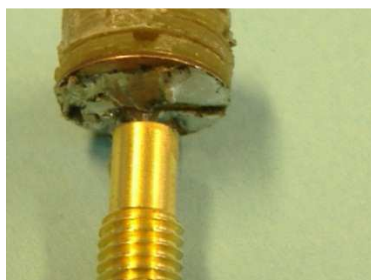
Figure 5.15. Intégration du circuit d'adaptation sur la face arrière du substrat de la première couche de l'antenne.
