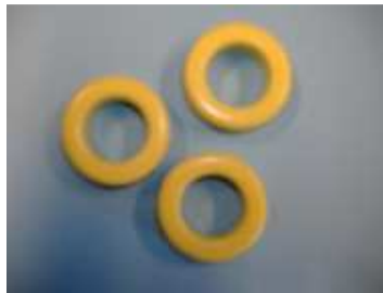
Figure 5.21. Ferrites utilisés pour limiter les courants de fuite dans le câble qui relie l'antenne de réception à l'analyseur de réseau.
