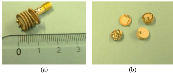
Figure 5.6. (a) bobine multicouche fabriquée sur substrat TMM6 ; (b) bobine détériorée.
