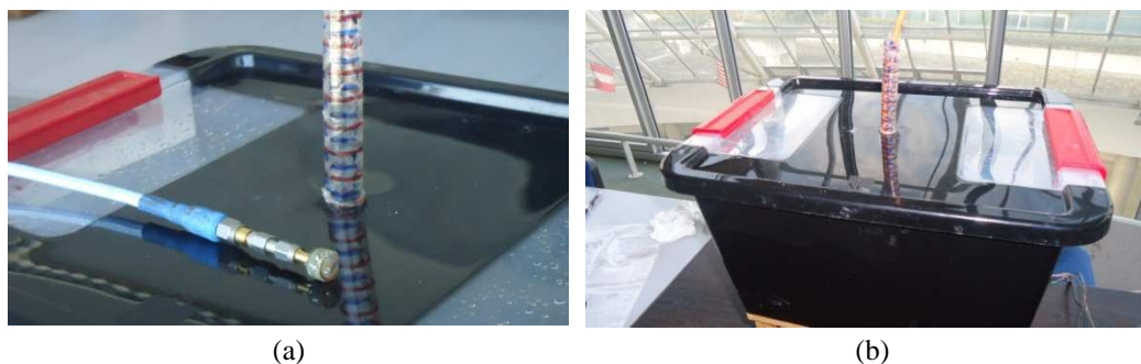
Figure 5.7. (a) Bobine d'émission reliée au câble ; (b) Bobine protégée par le tube et insérée dans le fantôme.
