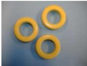
Figure 5.21. Ferrites utilisés pour limiter les courants de fuite dans le câble qui relie l'antenne de réception à l'analyseur de réseau.
