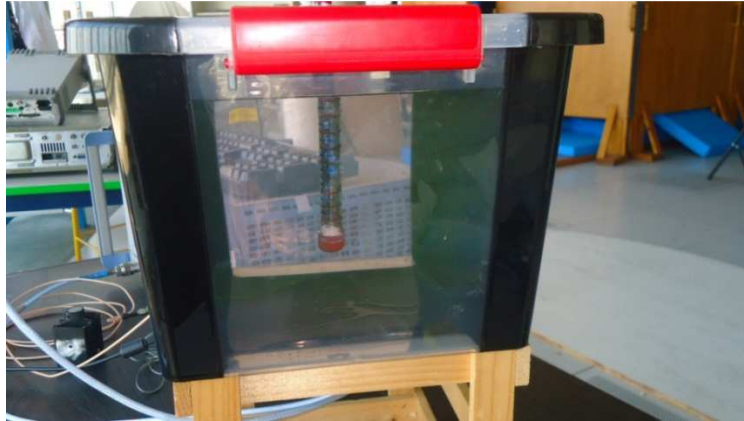
Figure 5.1. Fluide du tissu-équivalent humain : \epsilon_r = 64 et \sigma = 0.78 S/m à 40.68 MHz.
