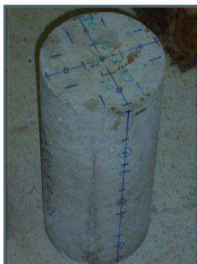
Figure 5: Positions des points de mesures ultrasonores
