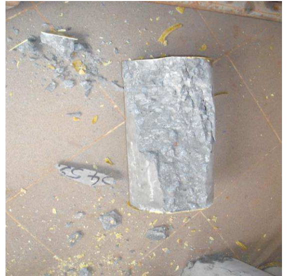
Béton de concassé + Gravier
