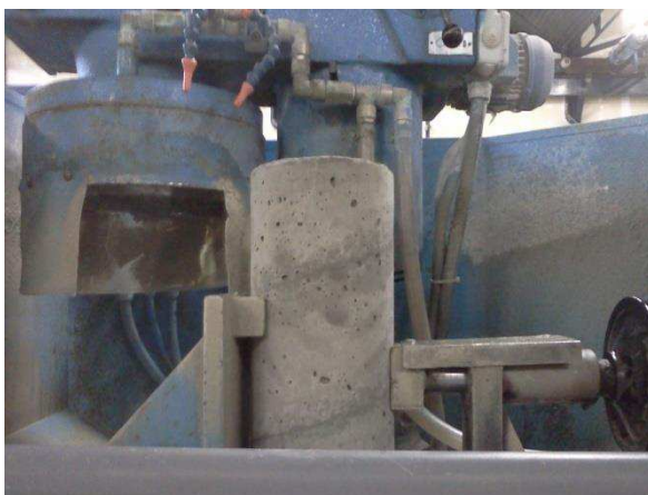
Figure 6: Rectification avec une meule diamantée
