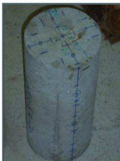
Figure 5: Positions des points de mesures ultrasonores
