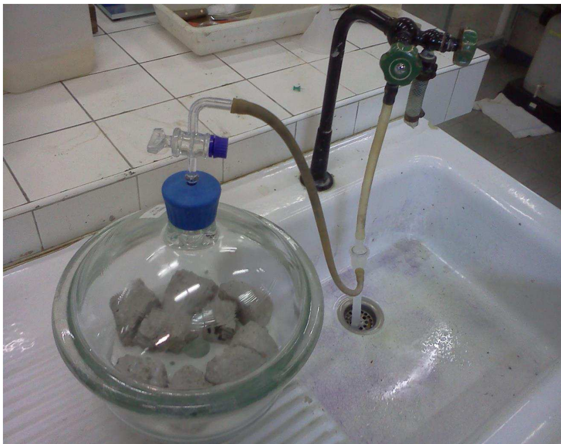
Figure 2: Dispositif expérimental pour la saturation sous vide
