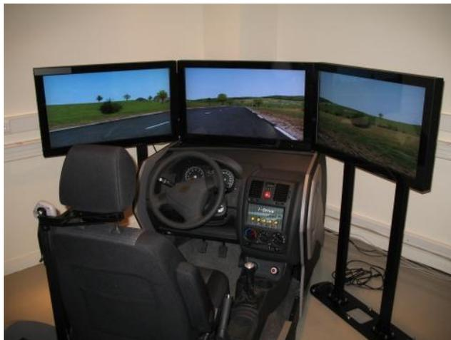
Figure 7 : Simulateur de conduite Oktal
