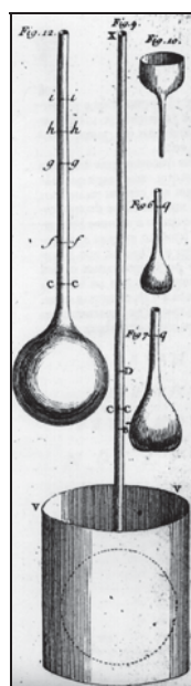
Fig 3.7 Dispositif pour obtenir la congélation de l'eau accompagné de mesures de grande capacité (Tirée de REAUMUR, 1730)
