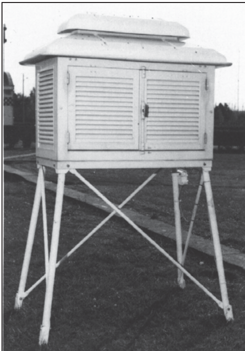
Fig 4.1 Abri météorologique utilisé actuellement en France (Photos Météo-France N° 11833, 8436)
