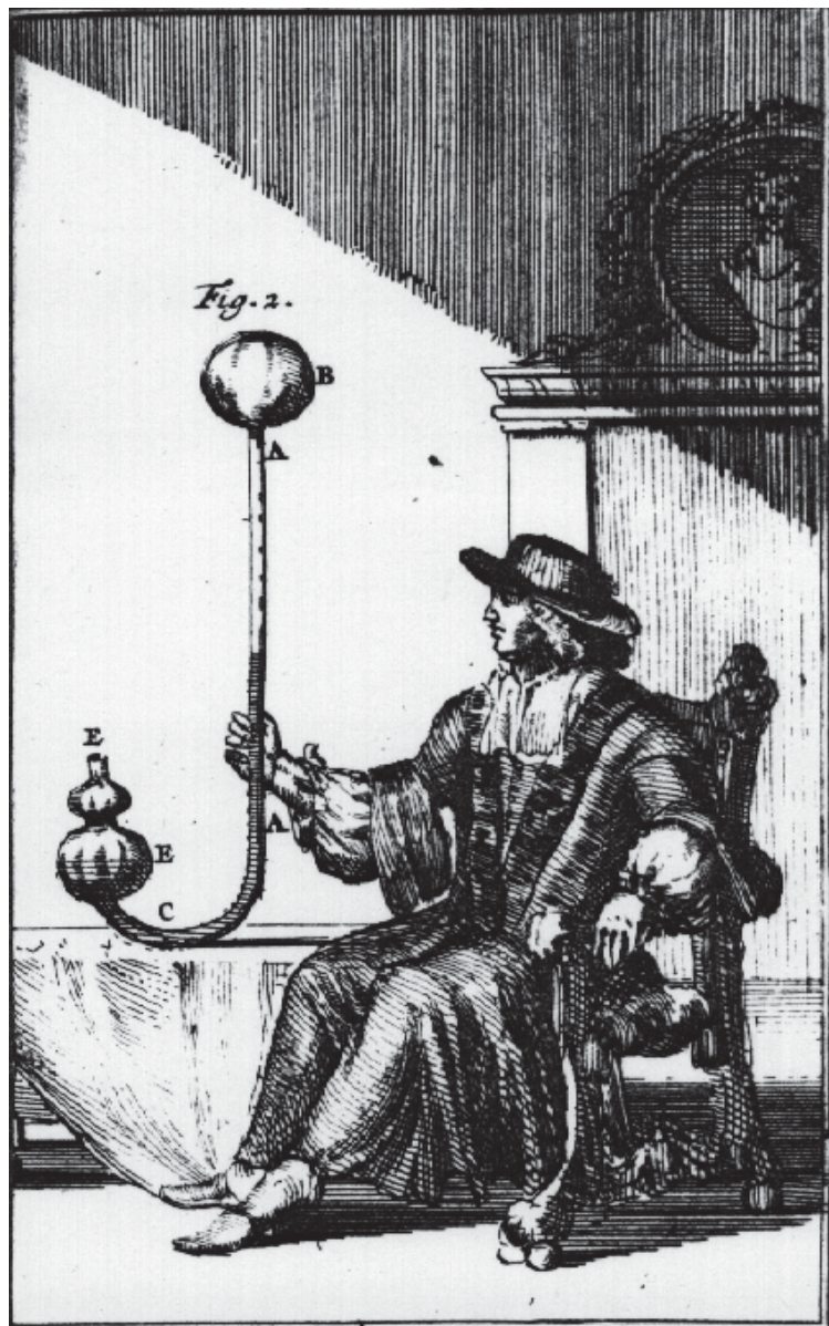
Fig. 1.2 Thermomètre à air, ou thermoscope à deux bulbes, dit le " Dutch " en forme de J (Illustration tirée de D'ALENCE p 65)
