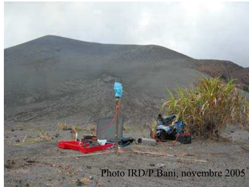
Figure 5-3. Mesure en position fixe sous le panache du Yasur dans le but d'étudier le comportement de la chimie du panache.
