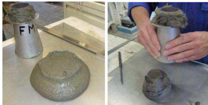
Figure 4.18 – Test au mini-cône sur mortier fluide : mortier fluide sans polymère EA (gauche), avec 0,25% de polymère EA (droite).
