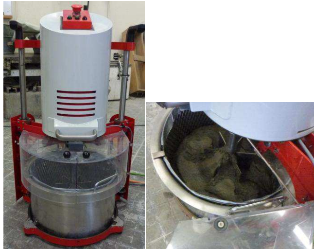
Figure 2.3 – BTRHEOM équipé de la géométrie Vane.
