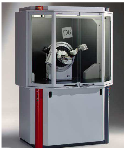
Figure 2.9 – Diffractomètre D8 Advance Bruker (photo de la documentation Bruker).
