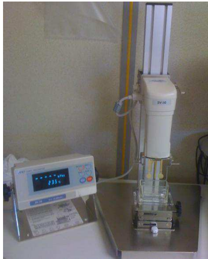
Figure 2.10 – Viscosimètre vibrant à onde sinusoïdale SV-10 A&D Company Limited.
