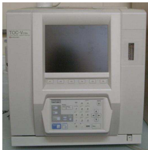
Figure 2.7 – Analyseur de carbone organique total TOC V CSH Shimadzu.
