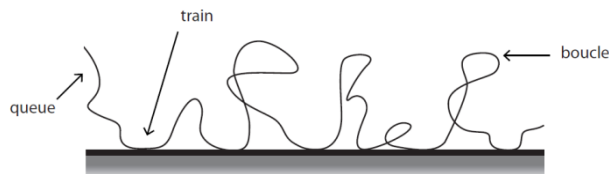
Figure 3.5 – Représentation schématique d'un polymère adsorbé à la surface d'une particule : modèle « train et boucle » (les segments attachés à la surface forment les trains et sont séparés par des boucles ; la queue est la fin du polymère).
