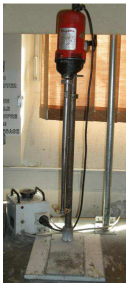
Figure 2.15 – Agitateur magnétique Turbo Test Rayneri Groupe VMI.
