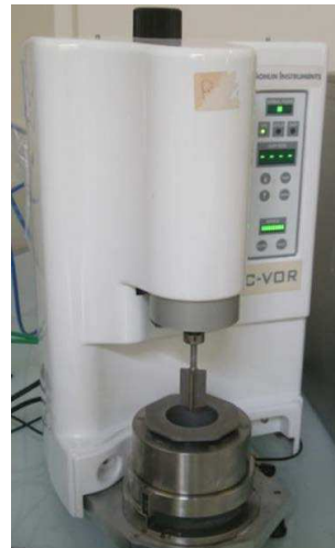
Figure 2.2 – Rhéomètre C-VOR Bohlin équipé de la géométrie Vane.
