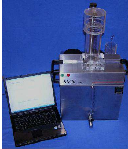
Figure 4.3 – Système AVA-3000 (photo de Germann Instruments) [33].
