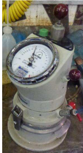
Figure 2.5 – Aéromètre à mortiers CONTROLAB.
