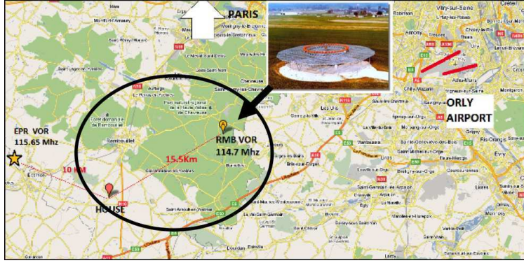
Figure 23: Configuration du banc de test déployé. L'émetteur sélectionné est le VOR de Rambouillet. Les récepteurs sont localisés au point marqué "HOUSE". Le cercle indique la région dans laquelle les avions sont détectés, de par le rapport signal-sur-bruit suffisamment élevé des signaux réfléchis par les avions.
