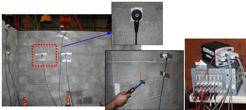
Fig. 4.48. (a) Disposition des accéléromètres sur le mur; (b) IMC CRONOS
