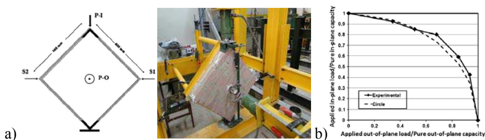
Fig. 1.21. Banc d'essai et résultats [NAJ 2013]
