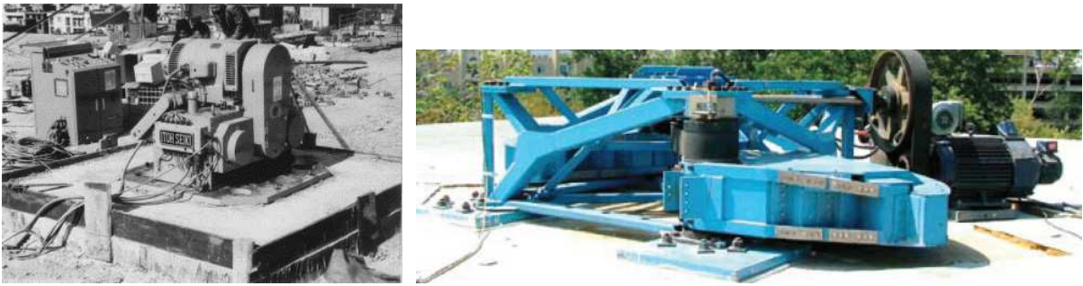
Fig. 2.31. Shaker: a) sur fondation [MAM 1998] ; b) en toiture de bâtiment [JOH 2007].
