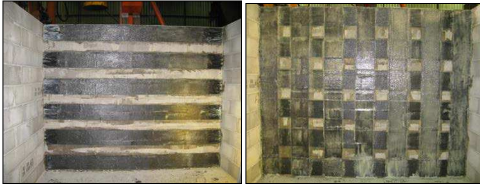
Fig. 2.18. Renforcement horizontal et vertical du mur n°3
