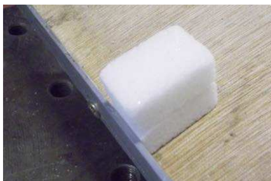
Fig. 4.62. Essai visant à déterminer l'angle de frottement entre les morceaux de sucre.
