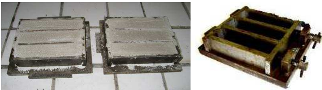
Fig. 2.35. Moules et éprouvettes de mortier
