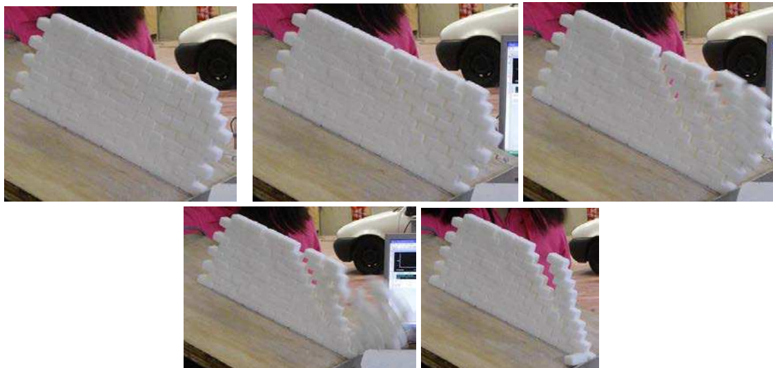
Fig. 4.68. Processus de rupture du mur dans le plan.
