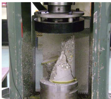
Fig. 2.62. Test en compression d'une éprouvette de béton 11x22cm
