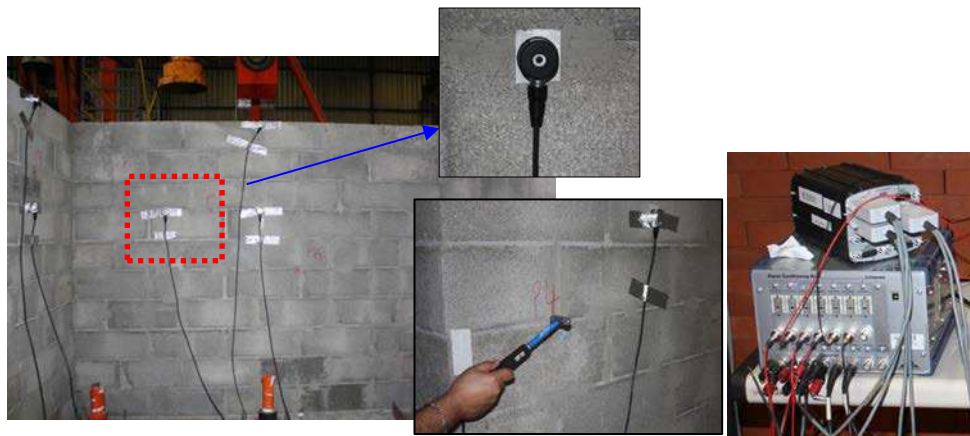
(a) (b) Fig. 4.48. (a) Disposition des accéléromètres sur le mur; (b) IMC CRONOS
