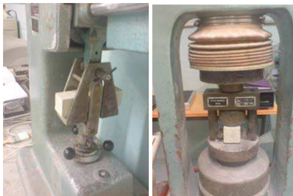
Fig. 2.41. a) Essai de flexion 3 points ; b) Essai de compression
