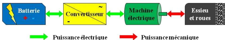
Figure 13 : Schéma bloc du véhicule électrique
