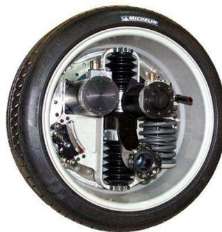
Figure 21 : Système Active Wheel de Michelin
