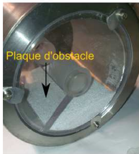
Fig. III.19: Montage de la plaque d'obstacle.
