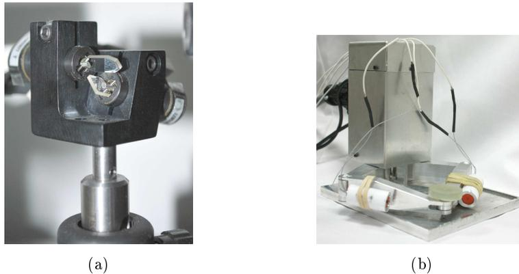
FIGURE 4.14 – (a) Photographie des galvanomètres utilisés au CEA. (b) Photographie du pantographe équipé de vibreurs Haptuator.
