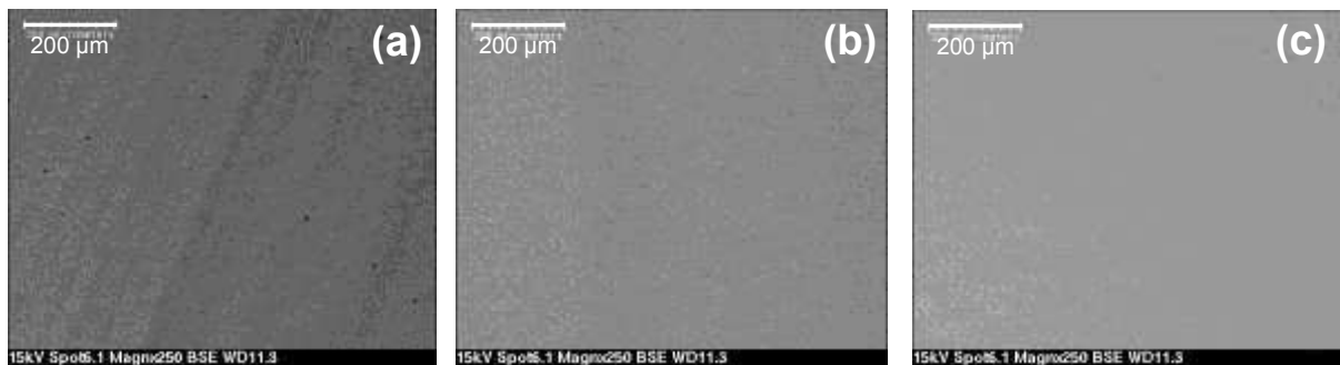
Figure 37. Clichés MEB en électrons rétrodiffusés des verres coulés sur plaque de la série BxNd4 : (a) B8Nd4 CP (b) B14Nd4 CP et (c) B20Nd4 CP.
