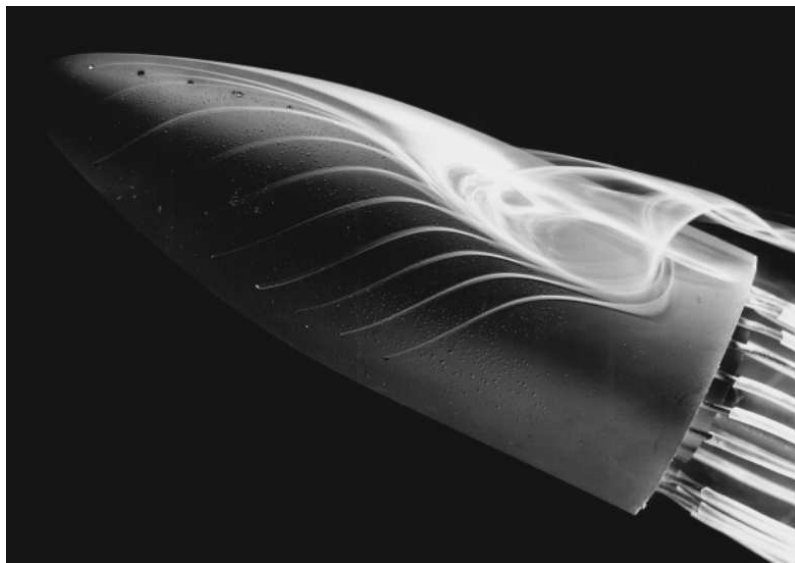
Fig 4.11: Visualisation expérimentale d'une séparation topologique à la surface d'un corps émoussé à symétrie de révolution (J. M. Détery 2001)
