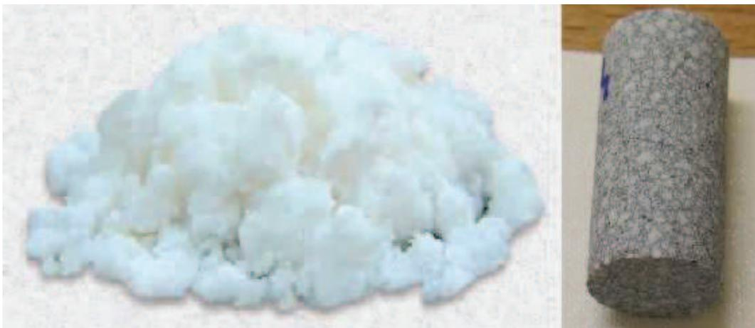
Figure I - 4 : Poudre de HMX (à gauche) et échantillon de diamètre 10 mm et de hauteur 20 mm obtenu après pressage et usinage (à droite).
