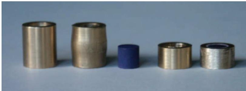
**Figure II - 6 : Photos de bagues avant et après essai avec à gauche les bagues longues et à droite les bagues de la hauteur de l'échantillon (au centre).**
