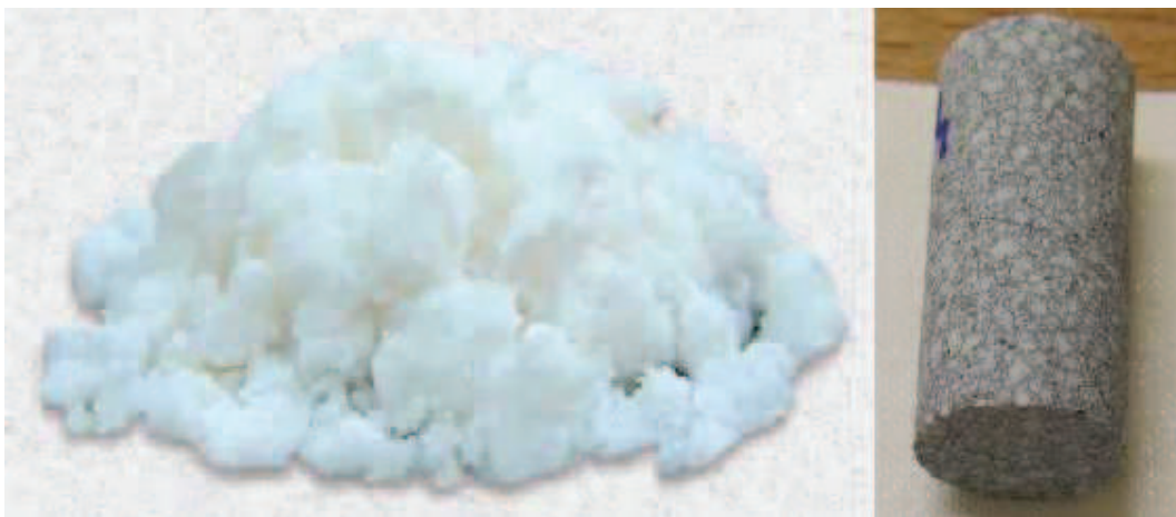
Figure I - 4 : Poudre de HMX (à gauche) et échantillon de diamètre 10 mm et de hauteur 20 mm obtenu après pressage et usinage (à droite).
