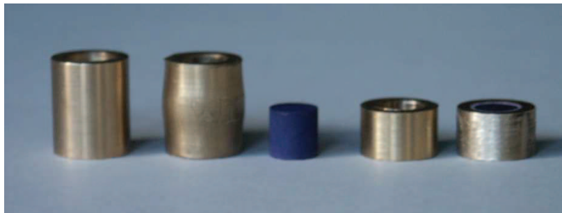
Figure II - 6 : Photos de bagues avant et après essai avec à gauche les bagues longues et à droite les bagues de la hauteur de l'échantillon (au centre).
