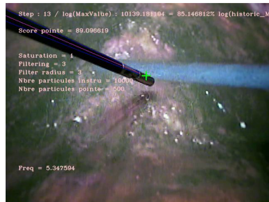
FIGURE 4.1. – Erreur importante dans la détermination de l’orientation de l’instrument, liée à un échec de la détection d’un des bords de l’instrument (image sélectionnée parmi les premières images de la séquence, avant que l’algorithme de CONDENSATION ne converge).
