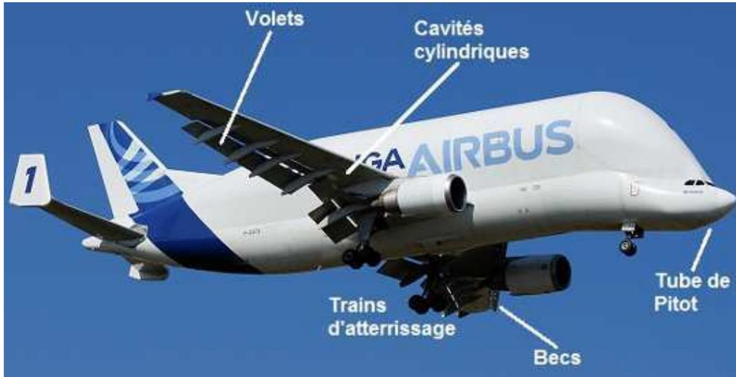
**FIGURE 3 – Localisation sur un avion (A300-600ST ou "Beluga") des principaux éléments intervenant dans le bruit de cellule.**
