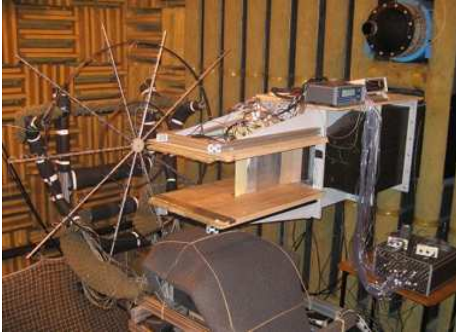
FIGURE 1.1 – Photo de l'installation dans la soufflerie anéchoïque du Centre Acoustique de l'ECL, montrant les plaques horizontales de maintien de la maquette et l'antenne de microphones de l'ONERA.
