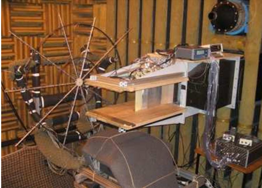
**FIGURE 1.1 – Photo de l'installation dans la soufflerie anéchoïque du Centre Acoustique de l'ECL, montrant les plaques horizontales de maintien de la maquette et l'antenne de microphones de l'ONERA.**
