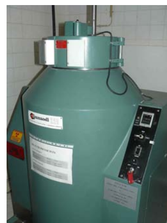
Figure 4. Irradiateur à rayons gamma ( ^{60}\text{Co} ). (IPCL, Seibersdorf)
