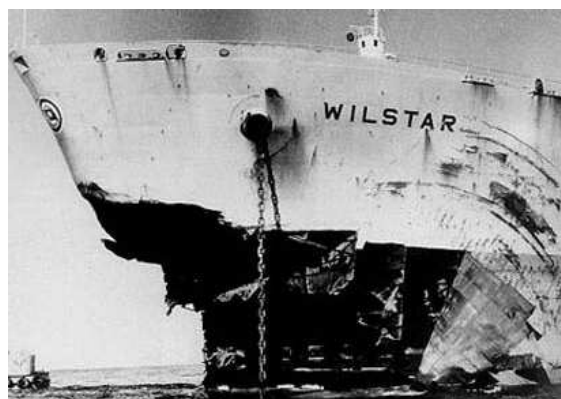
FIGURE 1.25 – Bateau endommagé par une “vague scélérate”.
