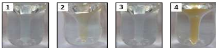
Figure 33. Evolution des phases IMAC au cours du temps. (1) phase POROS 20 MC neuve, (2) phase chargée en \text{Fe}^{3+} , (3) phase après une première régénération par l'EDTA, (4) phase après 20 cycles d'activation-régénération.
