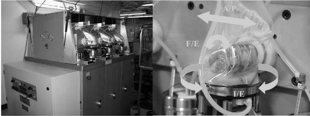
**Figure 2.10.** Simulateur de marche six-stations afin de mesurer l'usure de la prothèse de genou. A droite, vu rapprochée d'une station avec les mouvements possible représentés [Johnson'01].
