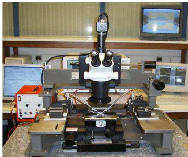
Figure. III.15 : Dispositif de mesure - station de mesure sous pointes, source DC et analyseur de réseaux vectoriel
