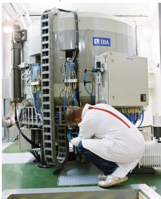
Figure I.26 – Le cyclotron du SHFJ (marque IBA, énergie 18.9 MeV) – Crédit : C.Boulze/CEA
