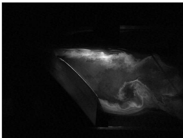
Fig. 5-1 – Visualisation de l'écoulement entièrement décollé à  $\delta = 37^\circ$  et  $U_\infty = 20 \text{ m.s}^{-1}$ .
