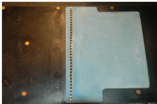
Fig. 2-3 – Vue de dessus des capteurs films chauds (et des fentes).
