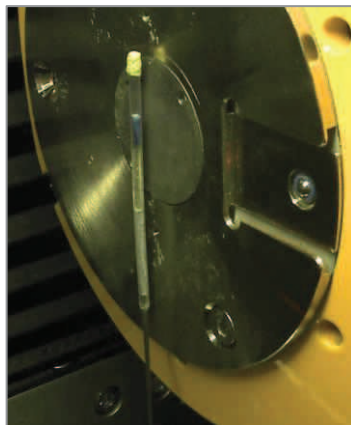
Figure 87 : Echantillon coloré au PTA mis en place dans son tube \varnothing 2mm devant le tube à rayons X du microtomographe.
