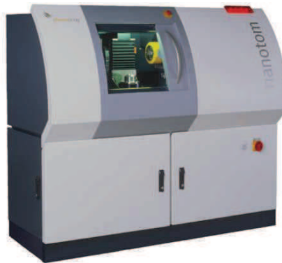
Figure 71 : Microtomographe X Phoenix Nanotom utilisé pour l'observation.
