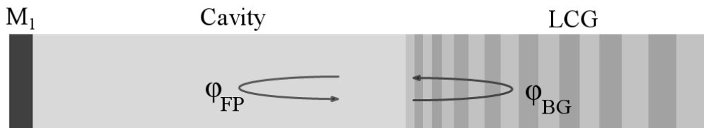
Fig. 7 Représentation d'une cavité résonnante réalisée avec un LCG, dans laquelle le décalage de phase aller-retour totale a été divisé entre le réseau de Bragg ( \varphi_{BG} ) et le reste de la cavité ( \varphi_{FP} ).
