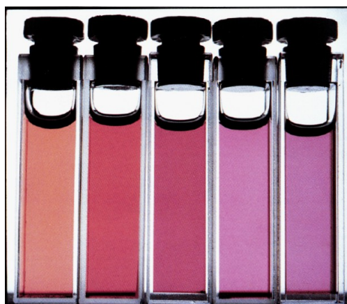
Figure I-7: Suspension de nanoparticules d'or de 16 nm de diamètre dans des solvants d'indice de réfraction croissant de gauche à droite : 1,336 (eau) et 1,407 ; 1,481 ; 1,525 et 1,583 (mélanges en proportions variables d'acétate de butyle et de disulfure de carbone). D'après [31].
