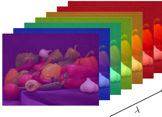
FIGURE 1.1 – Représentation des différentes bandes d’une image multispectrale
