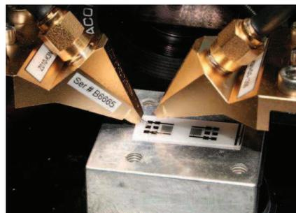
*Figure 2-34 : Cliché d'un IDT testé électriquement sous pointes*
