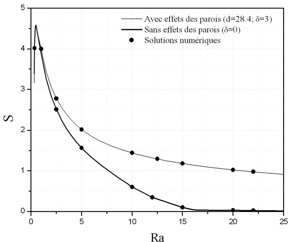
**FIGURE 4.5** – Courbes de la séparation en fonction du nombre de Rayleigh pour  $Le = 232$ ,  $\psi = 0.2$ ,  $d = 28.4$ ,  $\delta = 3$  (avec la prise en compte des caractéristiques des parois) et pour  $Le = 232$ ,  $\psi = 0.2$ ,  $\delta = 0$  (sans la prise en compte des caractéristiques des parois).
