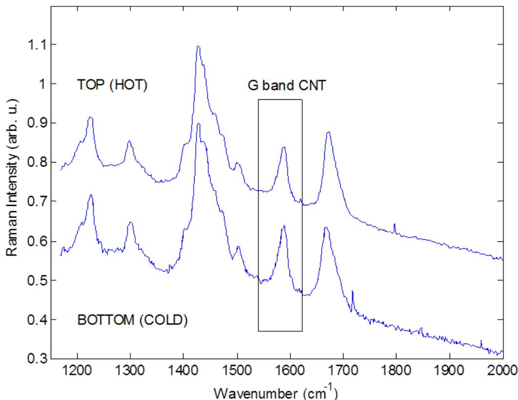
FIGURE 5.8 – Spectre de Raman obtenu pour l'expérience N-Methyl-2-Pyrrolidone + Nanotubes de carbone.
