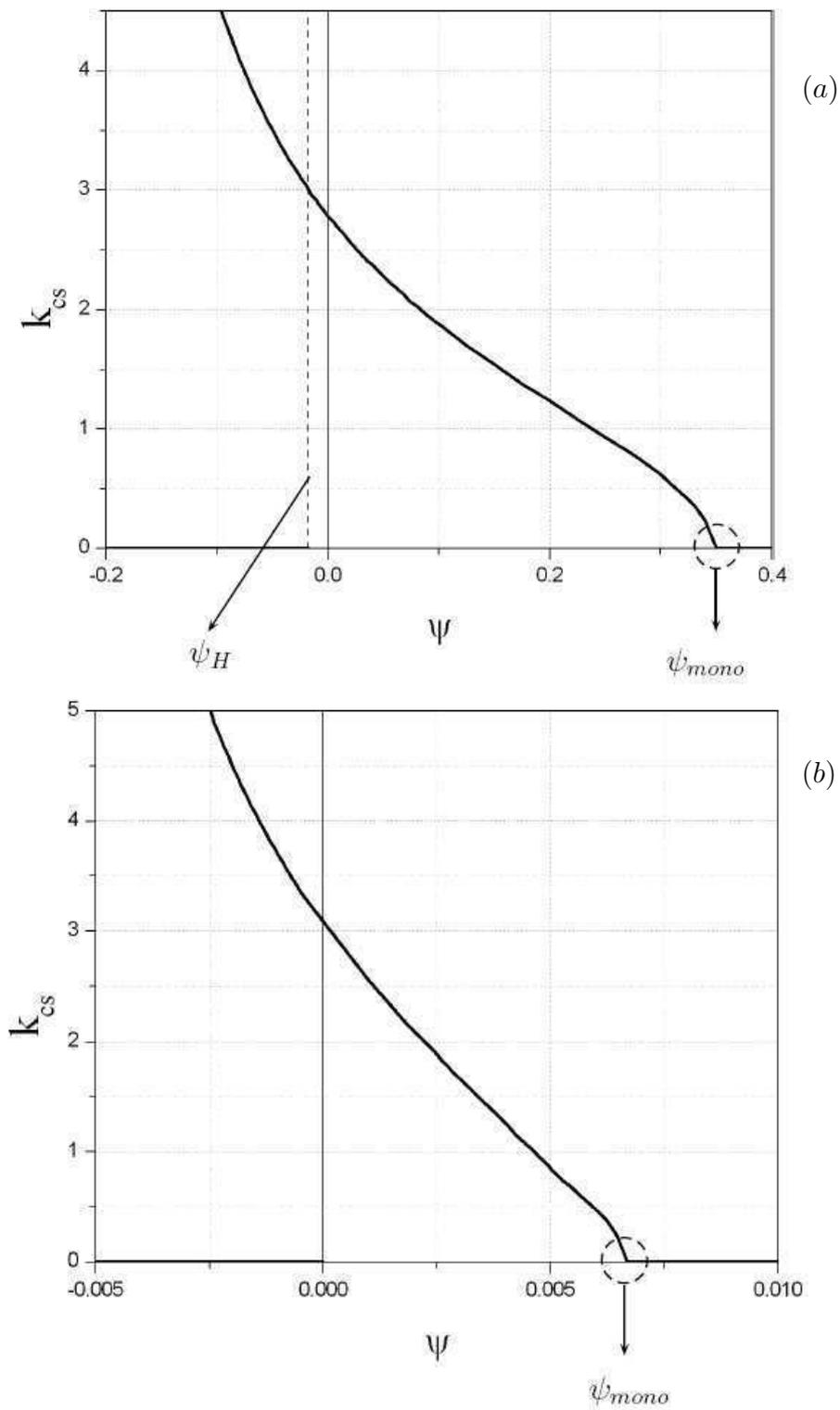
**FIGURE 3.5** – Diagramme de stabilité  $k_{cs} = f(\psi)$  pour (a)  $Le = 5$ ,  $d = 5$ ,  $\delta = 1$  et (b)  $Le = 232$ ,  $d = 28.4$  et  $\delta = 3$ . Trait discontinu :  $\psi_H = \frac{-1}{1 + (1 + 2d\delta)Le}$ .
