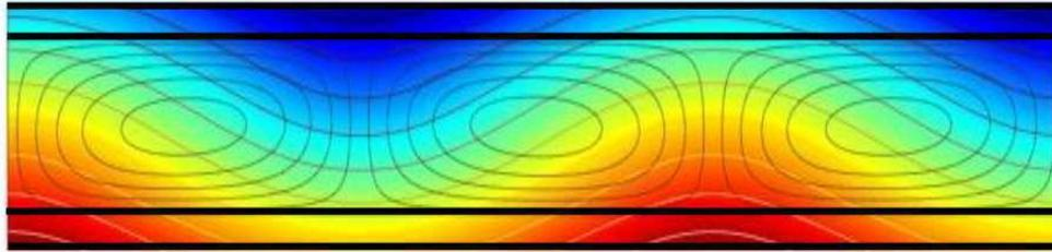
**FIGURE 1.1** – Profil de température au niveau des parois dans le cas d'une cavité poreuse chauffée par le bas et saturée par un mélange binaire.
