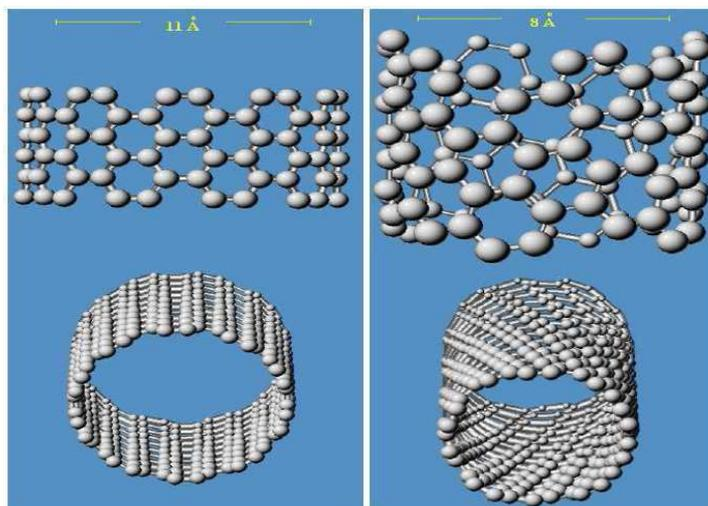
FIGURE 5.1 – Différentes structures de nanotubes identifiées.
