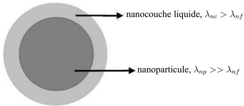
**FIGURE 5.4** – Illustration schématique représentant la superposition de liquide autour des nanoparticules.  $\lambda_{nc}$ ,  $\lambda_{nf}$  et  $\lambda_{np}$  sont respectivement la conductivité thermique de la nanocouche, du fluide de base, et de la nanoparticule.
