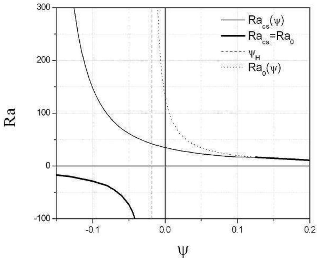
**FIGURE 3.3** – Diagramme de stabilité  $Ra_c = f(\psi)$  pour  $Le = 5$ ,  $d = 5$  et  $\delta = 1$ , trait discontinu :  $\psi_H = \frac{-1}{1 + (1 + 2d\delta)Le}$  et  $Ra_0 = \frac{12(1 + 2d\delta)}{1 + \psi(1 + Le + 2d\delta Le)}$ .
