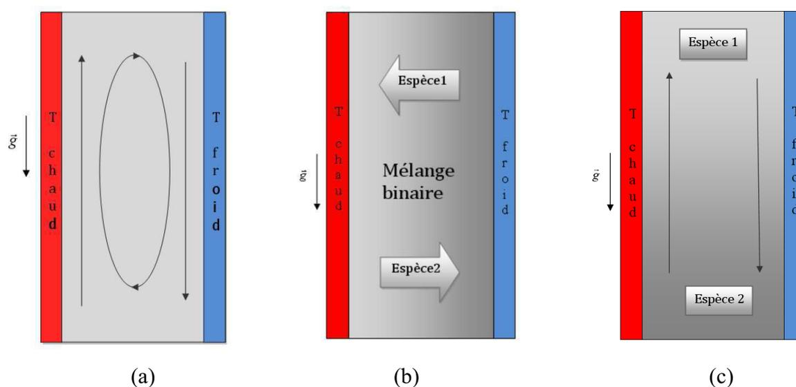
**FIGURE 1.2** – (a) Phénomène de convection naturelle dans une cavité différentiellement chauffée, (b) Diffusion thermique ou thermodiffusion, (c) Processus thermogravitationnel, répartition des concentrations à l'état stationnaire.
