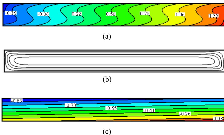
**FIGURE 4.2** – (a) Isoconcentrations, (b) Lignes de courant et (c) Isothermes pour  $Le = 232$ ,  $\psi = 0.2$ ,  $Ra = 4$ ,  $d = 0$ ,  $\delta = 0$ , (sans la prise en compte de l'influence des caractéristiques des parois),  $S = 1.86$ .
