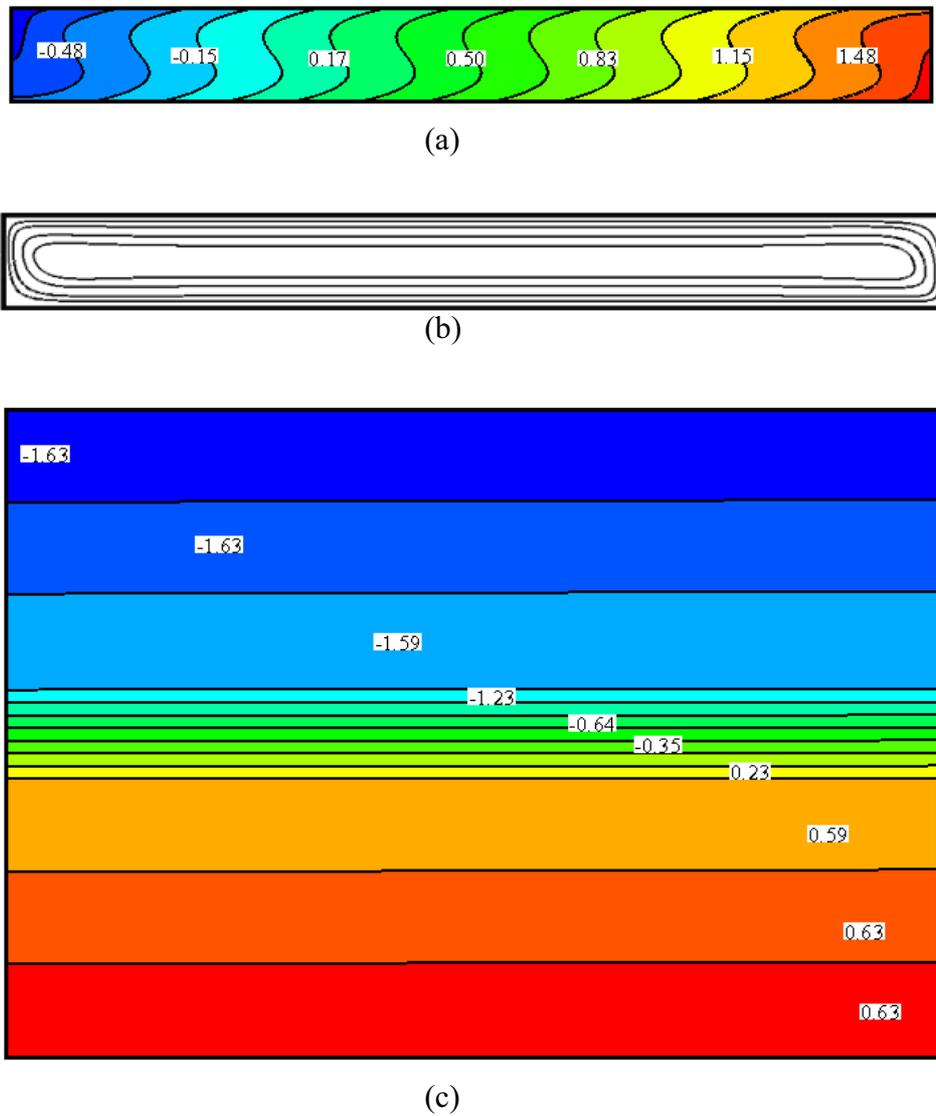
**FIGURE 4.3** – (a) Isoconcentrations, (b) Lignes de courant et (c) Isothermes pour  $Le = 232$ ,  $\psi = 0.2$ ,  $Ra = 4$ ,  $d = 28.4$ ,  $\delta = 3$ , (avec la prise en compte de l'influence des caractéristiques des parois),  $S = 2.24$ .
