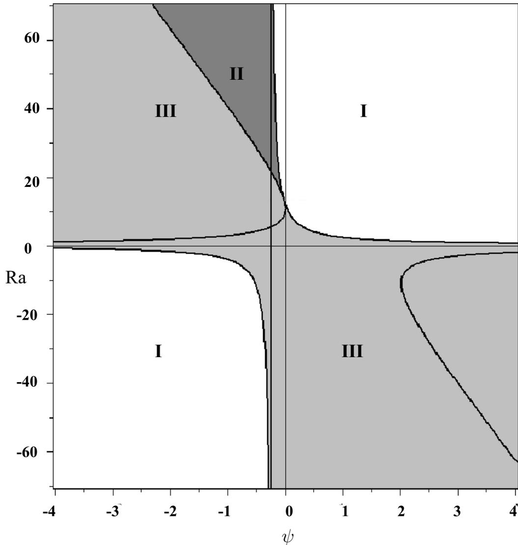
**FIGURE 4.1** – Régions du plan  $(Ra, \psi)$  correspondant aux différentes structures d'écoulement à l'intérieur de la cavité rectangulaire ( $A = 10$ ) pour  $Le = 3$ ,  $d = 1$  et  $\delta = 0.1$ .
