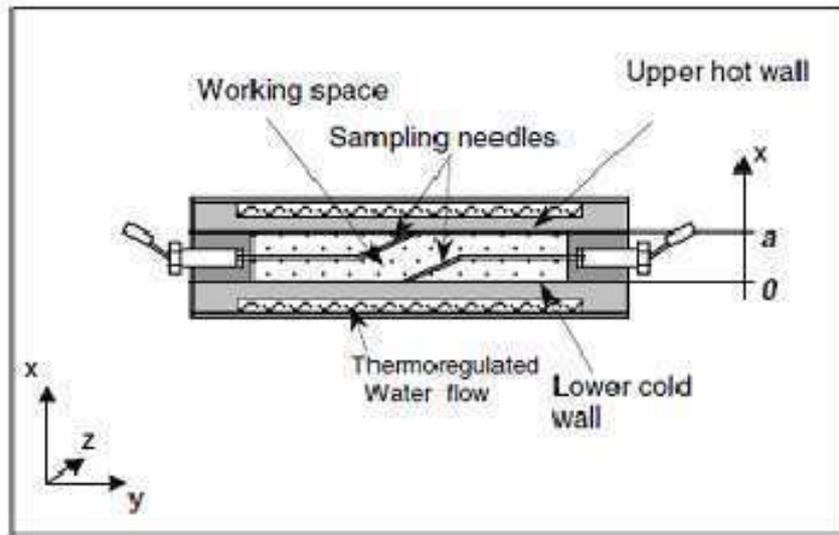
(a) Vue transversale de la cellule de thermodiffusion et du dispositif de prélèvement.
