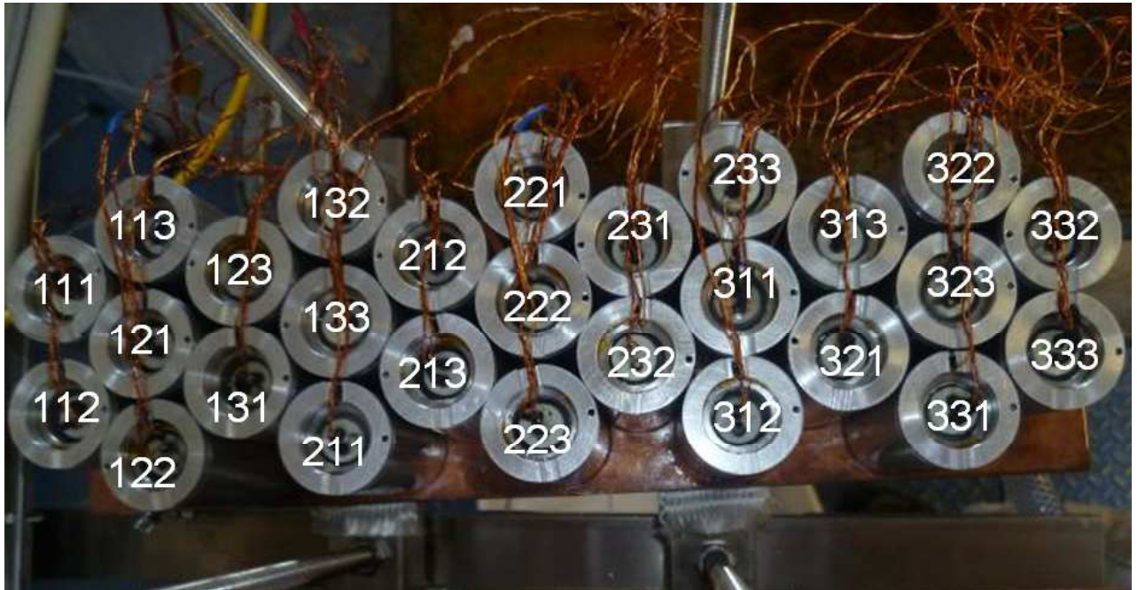
Figure V.4 : Positionnement et numérotation des éléments dans la section d'essais
