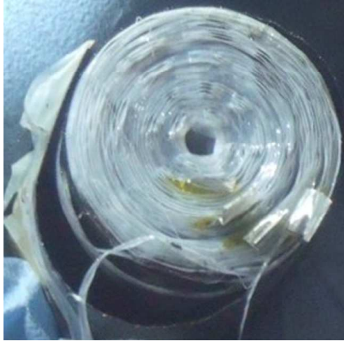
Figure II.3 : Matériaux constitutifs de l'élément LFP cylindrique
