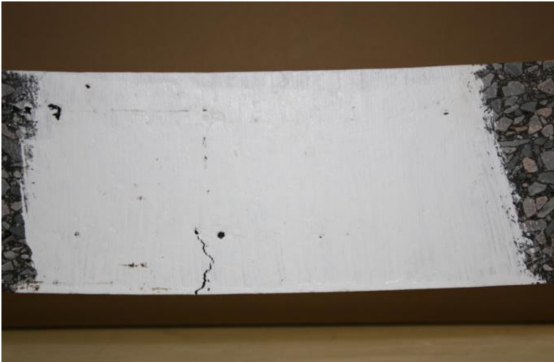
Figure i12. Etat de fissuration après 24h (1 jour) en flexion post-essai 4PB
