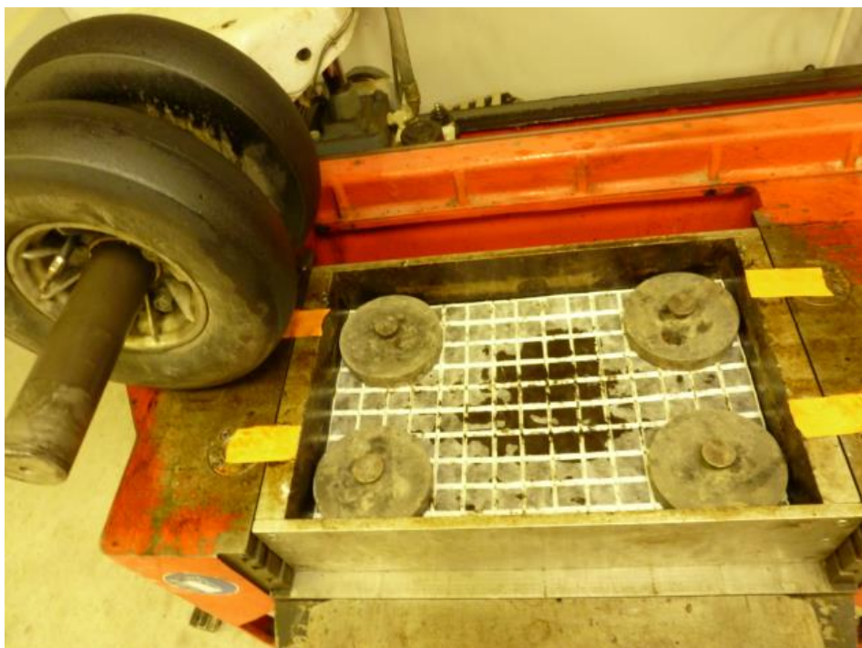
Figure b2. Collage de la grille CIDEX 100 SB et fixation à l'aide des poids
