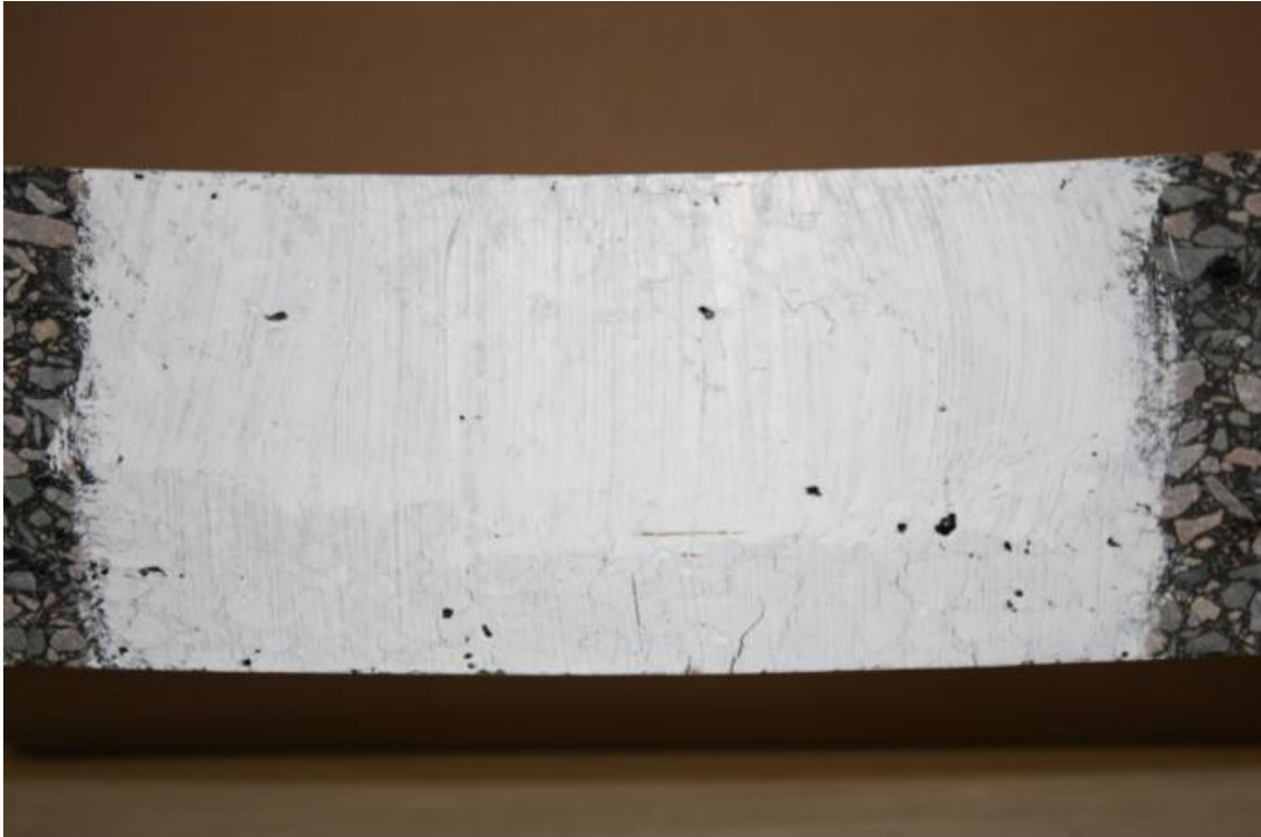
Figure i20. Etat de fissuration après 96h (4jours) en flexion post-essai 4PB
