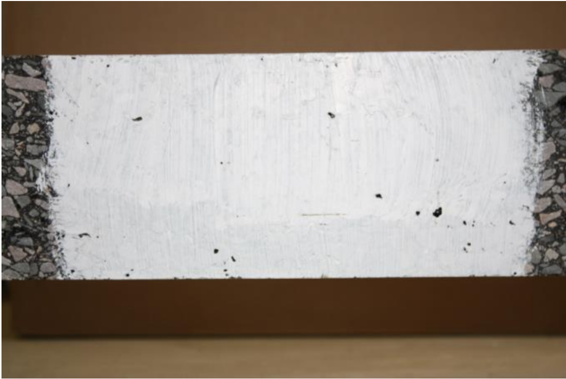
Figure i16. Etat de fissuration à 0h en flexion post-essai 4PB
