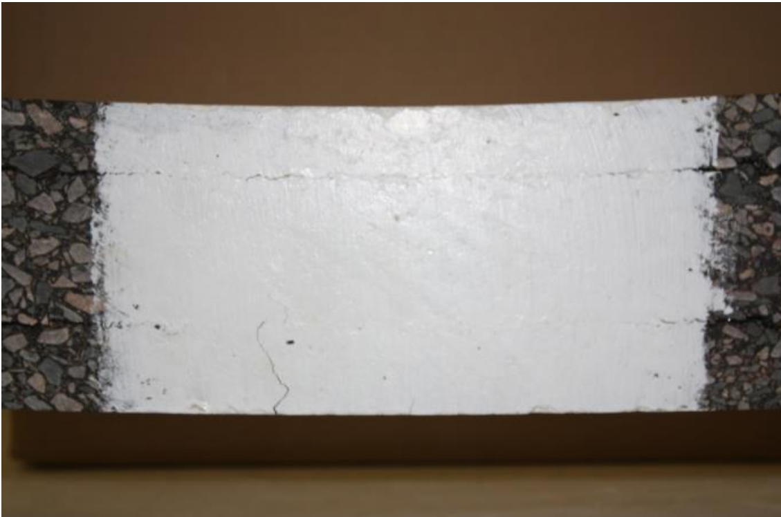
Figure i29. Etat de fissuration après 48h (2 jours) en flexion post-essai 4PB
