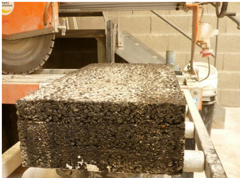
Figure b.4 Plaque en structure tri-couches avant le sciage
