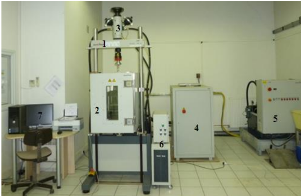
Figure 3.1 Système d'essai Zwick-Roell (photo I.A)
