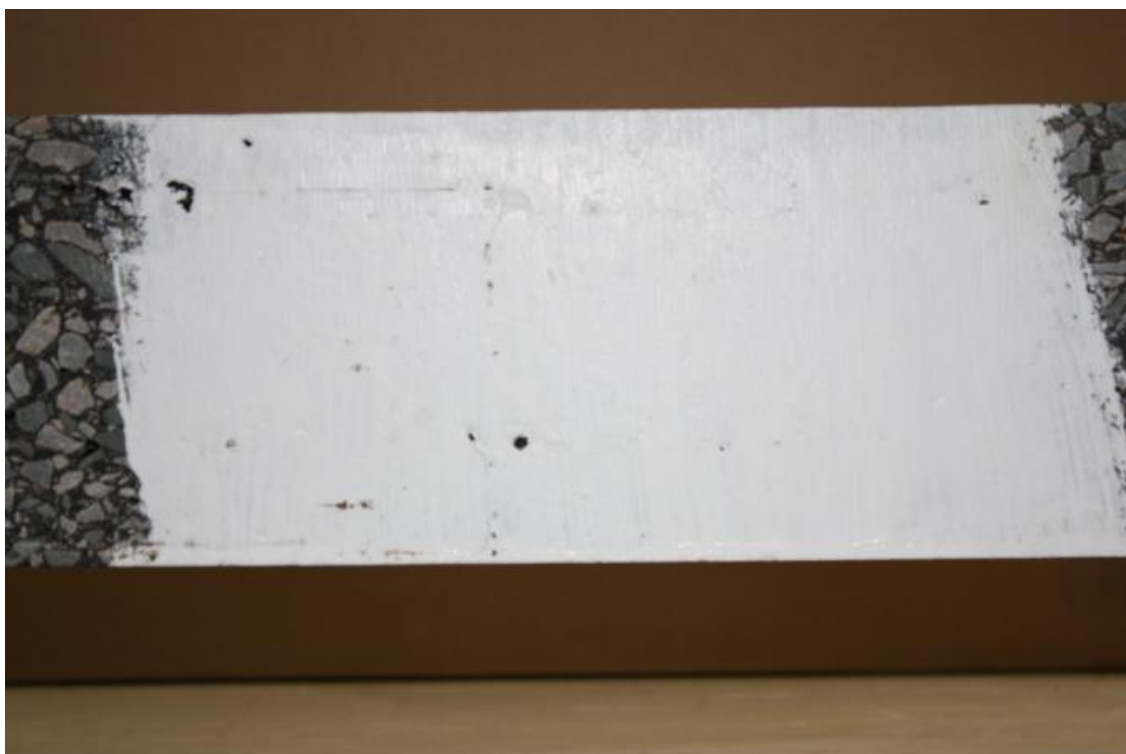
Figure 4.26 Etat de fissuration à 0 h de flexion de la poutre 17NR, post essai de fatigue à \epsilon = 115 \mu\text{m/m}
