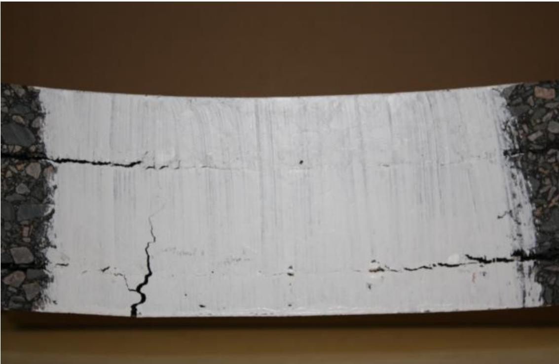
**Figure i37. Etat de fissuration après 34h (1 jour + 10 h) en flexion post-essai 4PB**
