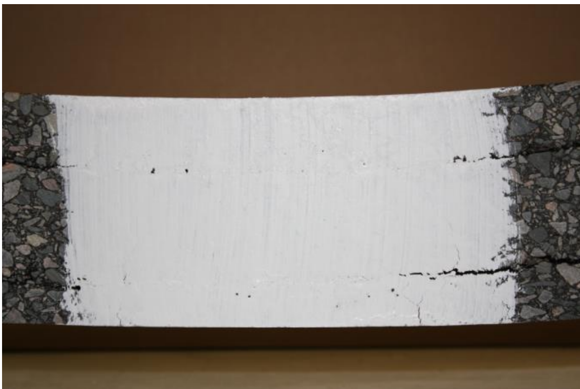
Figure 4.29 Etat de fissuration après 24 h de flexion de la poutre 20R, post-essai de fatigue à \epsilon = 115 \mu\text{m/m} . Dédoublément de la fissure macroscopique avant le niveau de l'interface et déviation au niveau de l'interface
