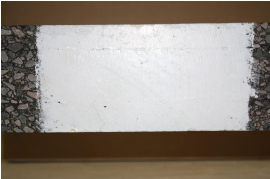
Figure i27. Etat de fissuration après 0h en flexion post-essai 4PB
