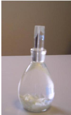
Figure a5. Pycnomètre avec fils de verre
