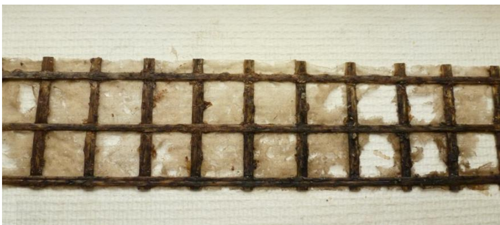
Figure 4.36 Géo-grille récupérée (et lavée avec solvant) après la flexion post essai de fatigue. La grille n'est pas rompue.
