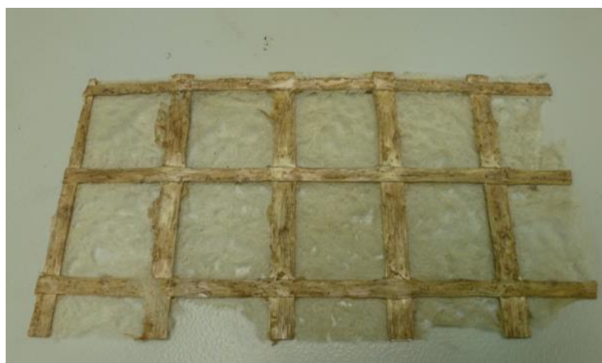
Figure 4.34 Géo-grille récupérée après l'essai de fatigue et lavée avec solvant. La grille n'est pas rompue.
