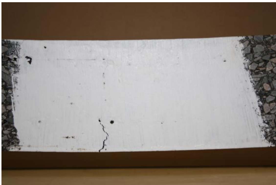
Figure 4.27 Etat de fissuration après 24 h de flexion de la poutre 17NR, post essai de fatigue à \epsilon = 115 \mu\text{m/m} . La fissure macroscopique se propage verticalement.
