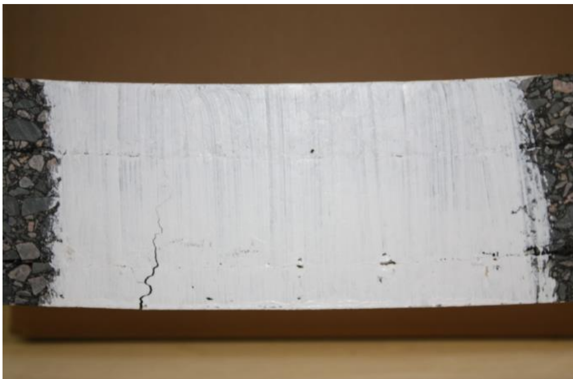
Figure i35. Etat de fissuration après 5h en flexion post-essai 4PB
