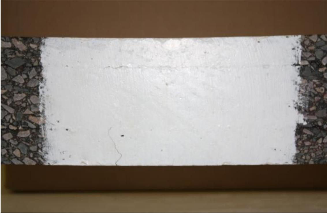
**Figure i28. Etat de fissuration après 24h (1 jour) en flexion post-essai 4PB**
