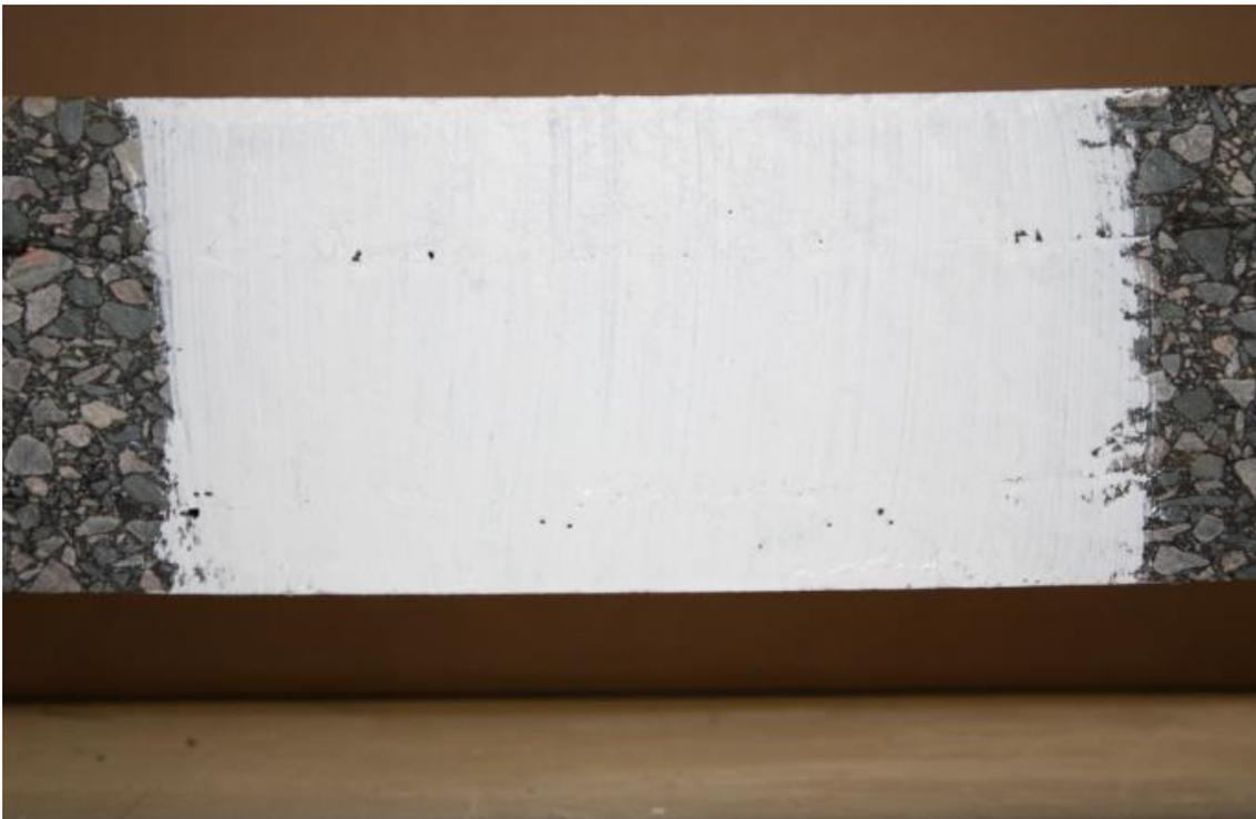
Figure i1. Etat de fissuration à 0 h en flexion post-essai 4PB
