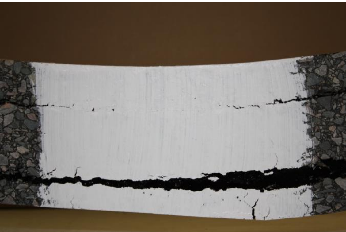
Figure i5. Etat de fissuration après 72h en flexion post-essai 4PB
