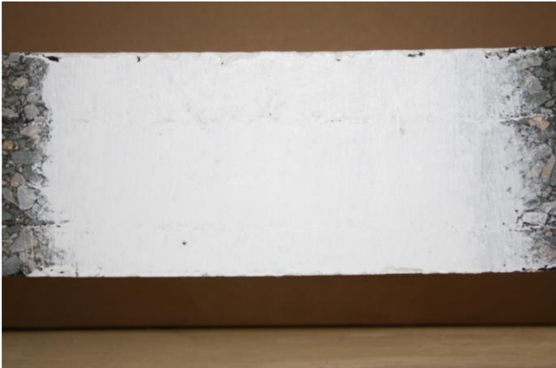
Figure i6. Etat de fissuration à 0h en flexion post-essai 4PB
