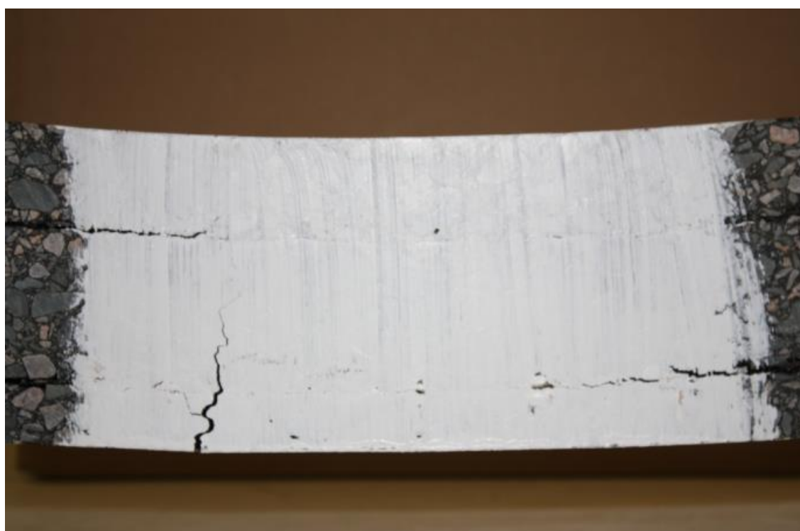
Figure 4.31 Etat de fissuration après 24h de flexion de la poutre 15R, post essai de fatigue à \epsilon = 129 \mu\text{m/m} . Dédoublage de la fissure macroscopique avant le niveau de l'interface.
