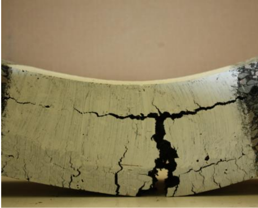
Figure i26. Etat de fissuration après 10 jours + 10 h en flexion post-essai 4PB
