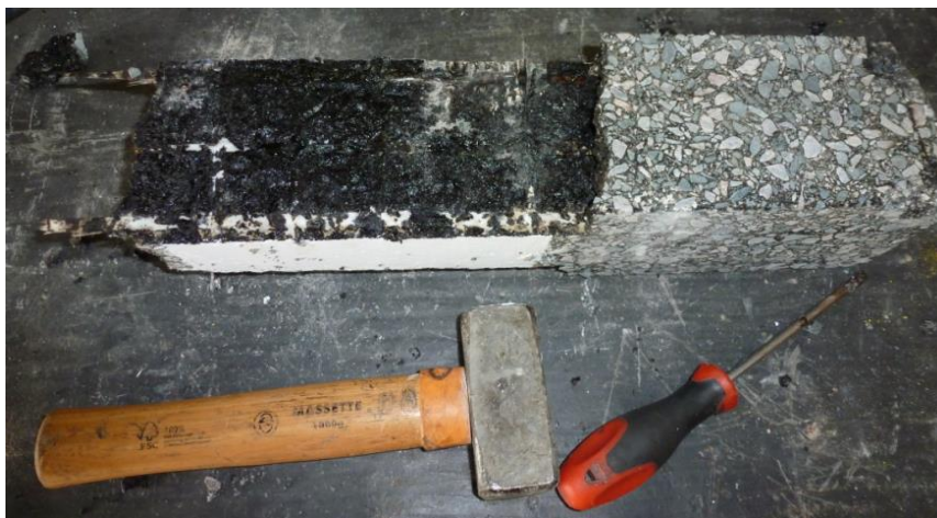
Figure 4.32 Récupération de la géo-grille après l'essai de fatigue
