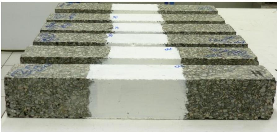
Figure b5. Eprouvettes – Poutres prismatiques 630 x 100 x 100 mm<sup>3</sup>, peinte au milieu avec une peinture blanche à l'eau pour observer la fissuration
