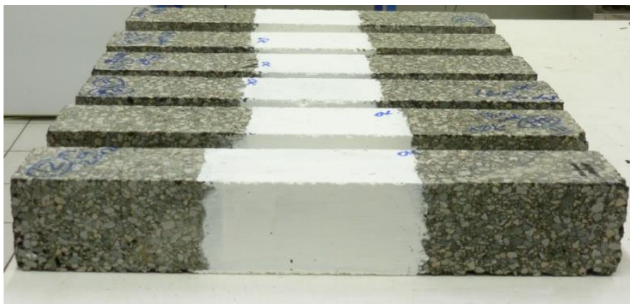
Figure b5. Epreuves – Poutres prismatiques 630 x 100 x 100 m 3 , peinte au milieu avec une peinture blanche à l'eau pour observer la fissuration
