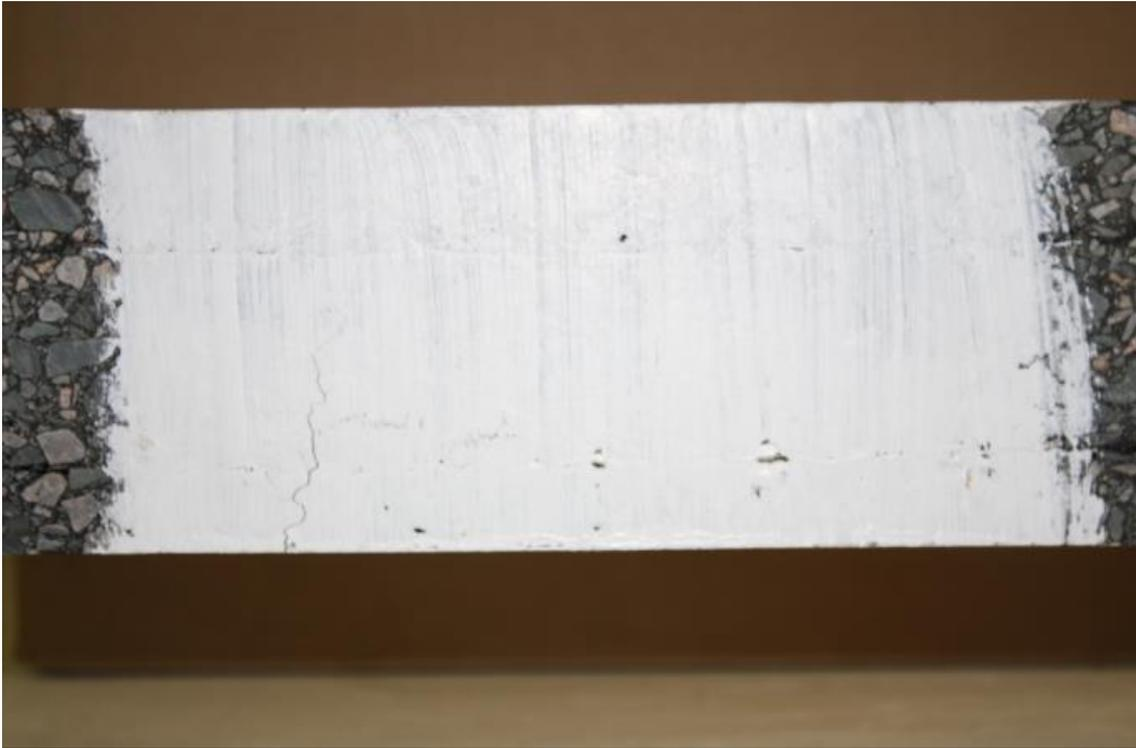
**Figure i34. Etat de fissuration à 0h en flexion post-essai 4PB**
