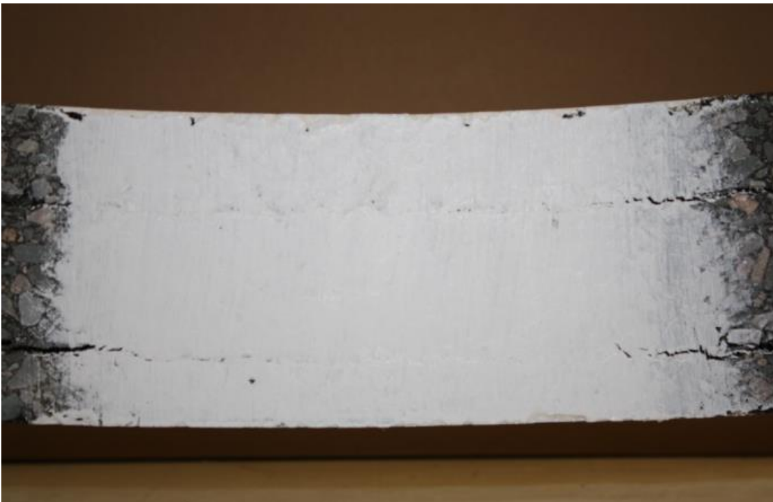
Figure i7. Etat de fissuration à 24h (1jour) en flexion post-essai 4PB
