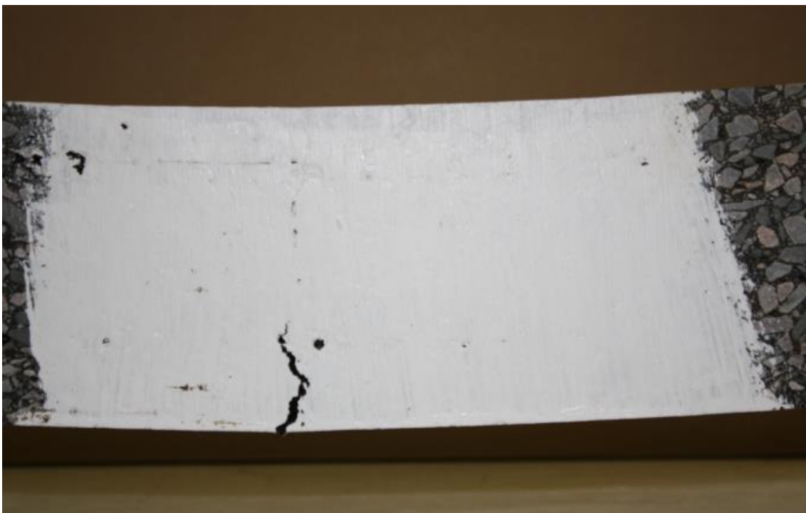
Figure i13. Etat de fissuration après 48h (2 jours) en flexion post-essai 4PB
