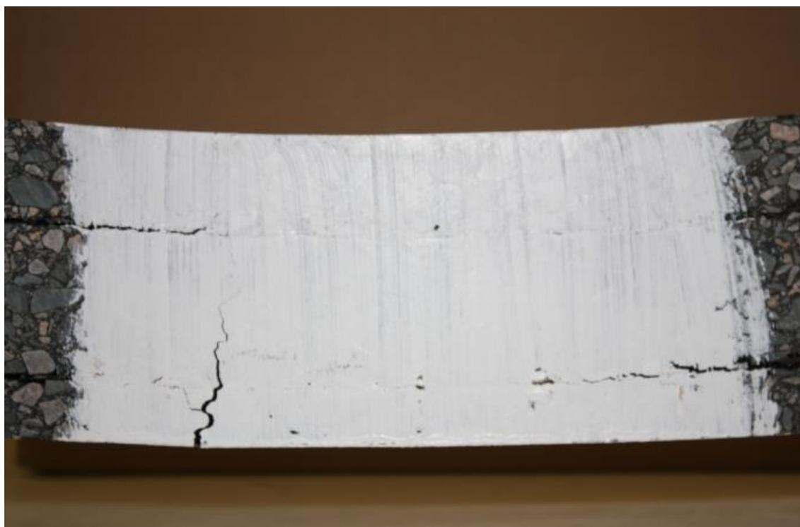
Figure 4.31 Etat de fissuration après 24h de flexion de la poutre 15R, post essai de fatigue à  $\epsilon = 129 \mu\text{m/m}$ .
