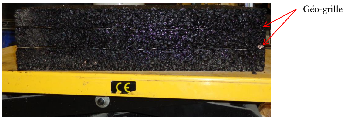
Figure 3.5 Plaque renforcée en structure tri-couche, fabriquée à Epsilon (photo I.A)
