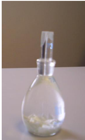
Figure a5. Pycnomètre avec fils de verre
