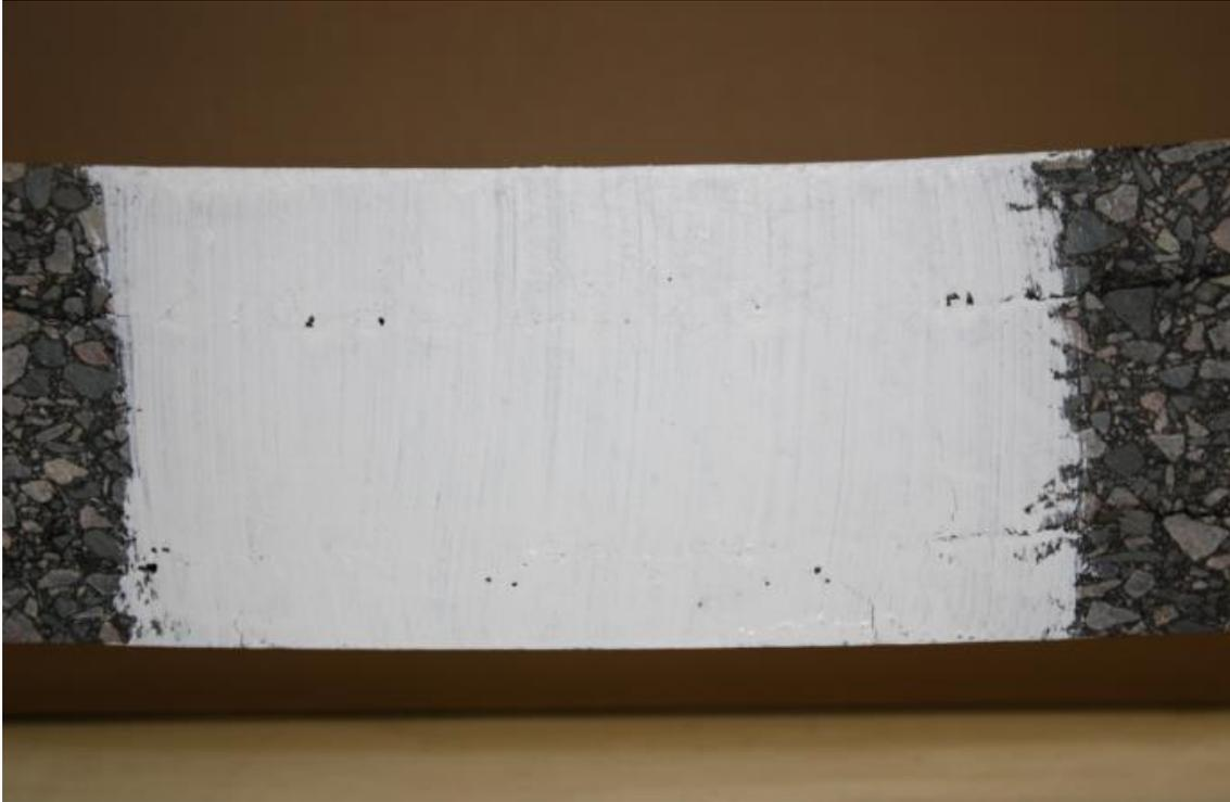
**Figure i2. Etat de fissuration après 5h en flexion post-essai 4PB**
