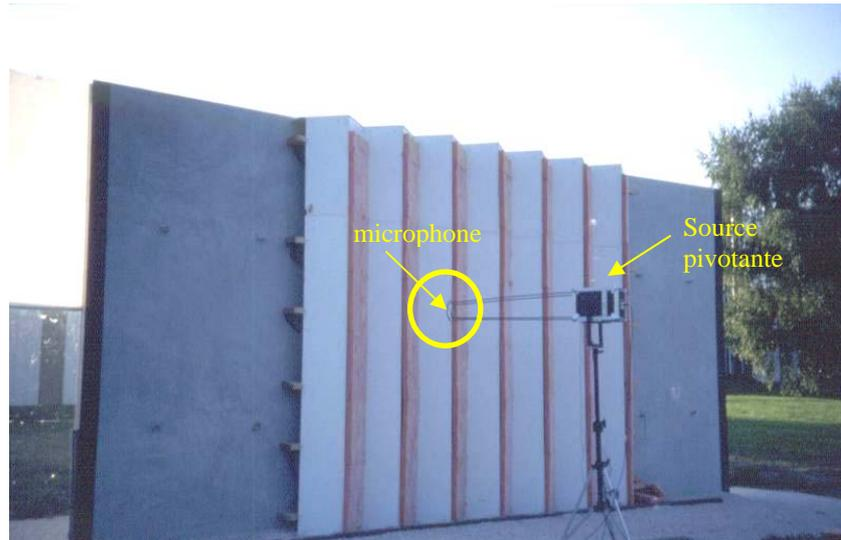
**Figure 2.5.** Dispositif « Adrienne » de mesure de l'absorption et de la transmission acoustique des écrans antibruit face à un prototype d'écran « zigzag ». La source peut pivoter dans le plan perpendiculaire à l'écran et autour d'un axe horizontal parallèle à l'écran.
