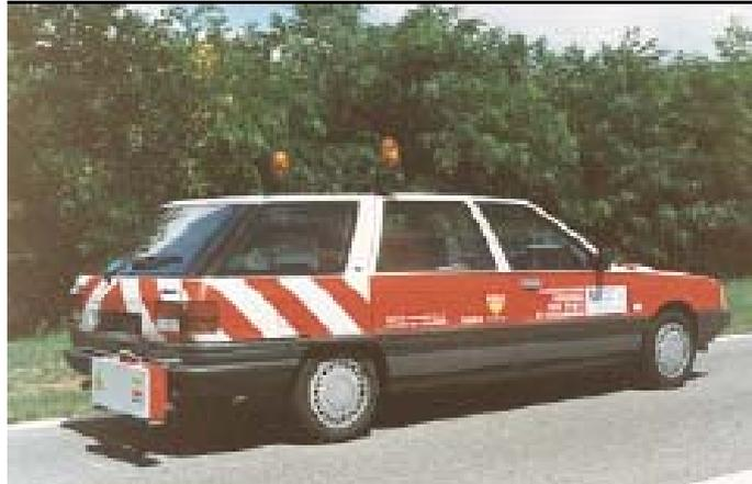
**Figure 3.14.** Mesure dynamique du profil de texture de chaussée, appareil Rugo©
