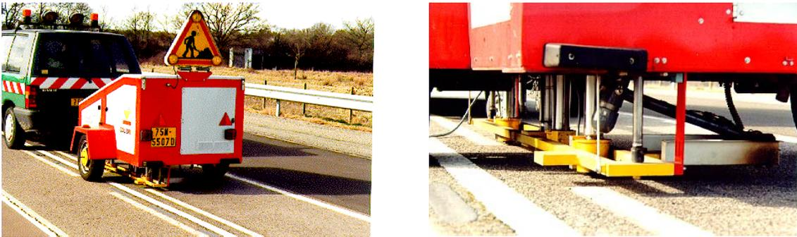
**Figure 3.4.** Détermination expérimentale de réponse impulsionnelle d'une chaussée à l'aide de l'appareil « COLIBRI ». *Figure 3 in [C17]*
