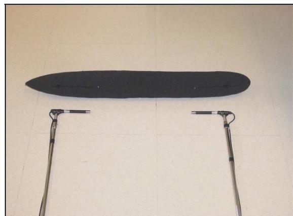
**Figure 4.3.** Dispositifs de protections microphoniques conçus pour limiter le bruit aérodynamique : protections profilées (gauche), protection bi-microphonique (droite)
