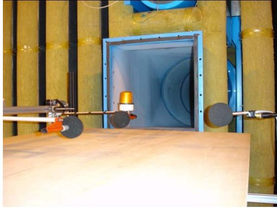
**Figure 4.2.** Mesure du bruit aérodynamique subi par les microphones latéraux en veine d'air silencieuse (Ecole Centrale de Lyon)
