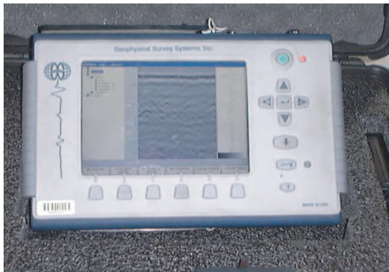
FIG. 1.9 – Exemple de radar impulsif portable (SIR-3000, marque GSSI).
