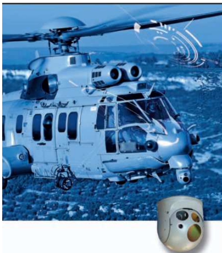
Figure 1 – Viseur SAGEM de type boule gyrostabilisée sur un hélicoptère
