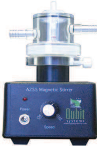
Figure 19 : Chambre polarographique utilisée dans cette étude (à gauche) et exemple de tracés obtenus lors du suivi de la consommation en oxygène d'une préparation mitochondriale, suite à l'ajout de substrat (glutamate ou succinate) et d'ADP (à droite). Les trois tracés correspondent à un même essai réalisé dans trois chambres polarographiques en simultané.
