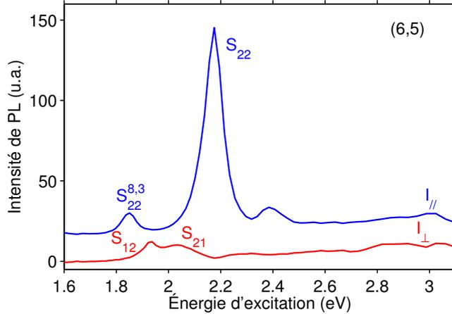
FIGURE 1.14 – Spectres de PLE de nanotubes (6,5) en suspension (émission intégrée sur  $1,26 \pm 0,01$  eV) où les composantes parallèle et perpendiculaire à l'axe du tube ont été extraites à l'aide de la procédure décrite dans le texte.
