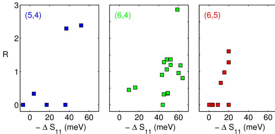
FIGURE 3.27 – Étude statistique sur une trentaine de composés uniques NT/TPP de l'évolution du rapport de transfert  $R$  en fonction du décalage spectral vers le rouge  $-\Delta S_{11}$ . La référence d'énergie de la transition  $S_{11}$  est prise à partir des mesures faites sur les solutions de nanotubes équivalents non fonctionnalisés.
