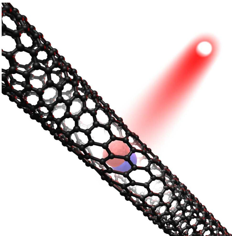
Recombinaison d'une paire électron-trou excitonique provoquant l'émission d'un photon infrarouge et d'un phonon acoustique.
