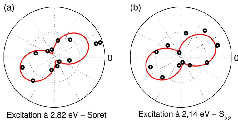
FIGURE 3.29 – Diagrammes typiques de polarisation en excitation à (a) 2,82 eV et (b) 2,14 eV pour un unique composé NT/TPP (6, 5).
