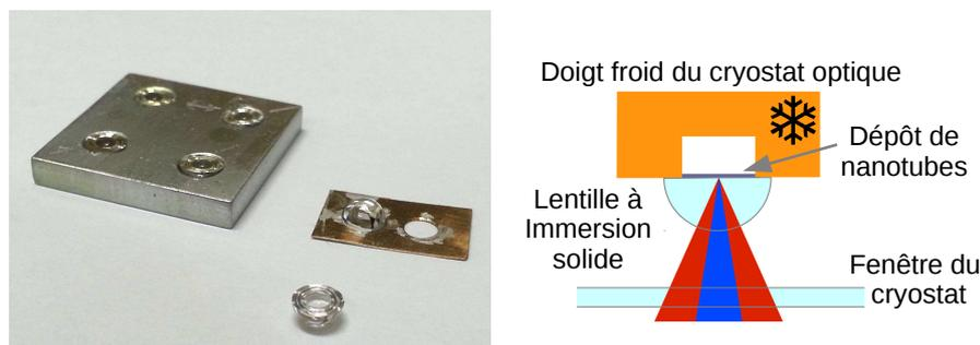
FIGURE 1.17 – Lentilles à immersion solide présentées avec le support de *spin-coating* et le support pour les mesures de PL. À droite une représentation schématique illustre la configuration expérimentale.
