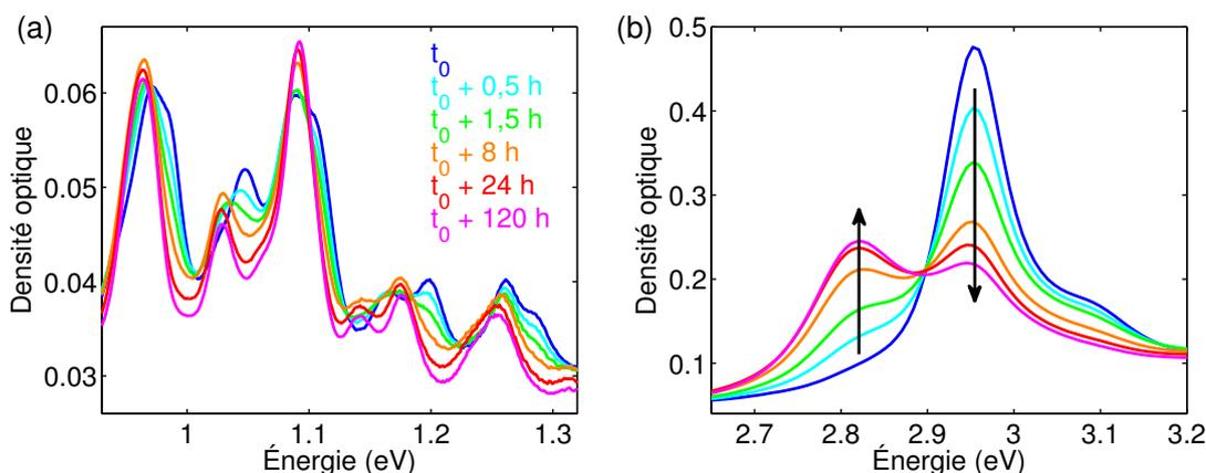
FIGURE 3.12 – Spectres d'absorption d'un mélange micellaire de nanotubes HiPCO et de molécules de TPP pour différents temps postérieurs à la mise en contact des réactifs ( $t = t_0$ ). Les courbes sont séparées en 2 zones spectrales permettant de suivre en parallèle l'évolution des (a) nanotubes et des (b) TPP. Une fonctionnalisation spontanée est observée à l'échelle de plusieurs jours.
