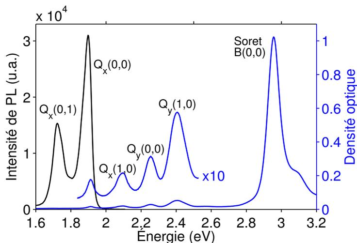
FIGURE 3.4 – Spectres d’absorption (bleu) et de photoluminescence (noir) d’une solution de TPP en micelles.
