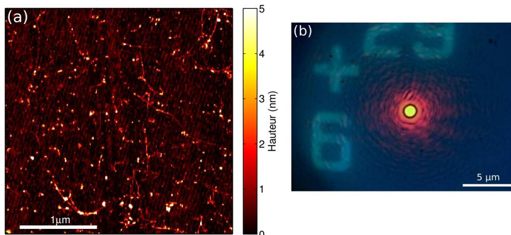
FIGURE 1.16 – (a) Mesure AFM d’un dépôt typique d’une solution de nanotube, effectué ici sur silicium pour limiter la rugosité du substrat. (b) Image optique de la surface d’un substrat au travers du système confocal de mesure. On peut identifier les repères métalliques et la tache d’excitation laser.
