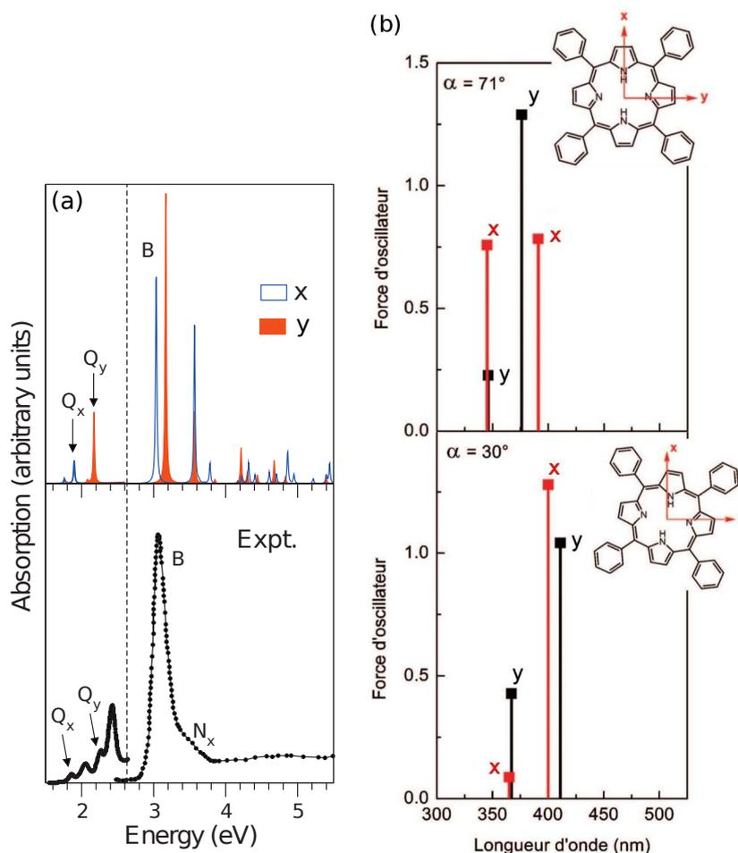
FIGURE 3.35 – Évaluation numérique de l’anisotropie des transitions optiques d’une molécule de TPP. (a) Extrait de [111]. (b) Calculs de G. Clavier en variant  $\alpha$  l’angle entre les phényles libres et le plan de la molécule de TPP.
