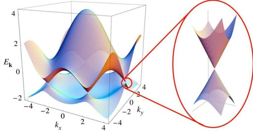
FIGURE 1.5 – Représentation tridimensionnelle de la dispersion du graphène (les coordonnées  $(k_x, k_y)$  sont tournées d'un angle  $\pi/3$  par rapport à notre définition). Au voisinage des points  $K$ , la dispersion est isotrope et linéaire. Tiré de [26].
