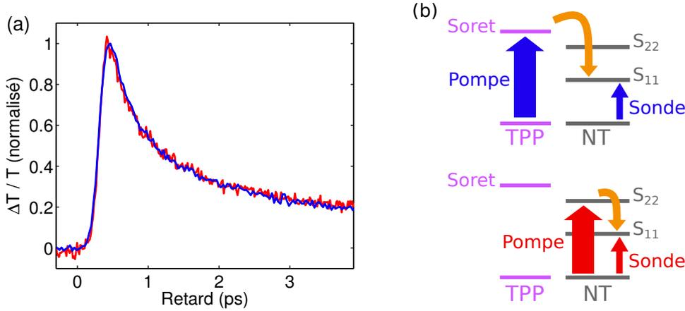
FIGURE 4.5 – (a) Variation relative de la transmission sur la transition  $S_{11}$  des nanotubes (6, 5) sur une même solution de composés NT/TPP, pour une excitation via transfert d'énergie (bleu) et une excitation sur la transition  $S_{22}$  des tubes (rouge). Les valeurs sont normalisées pour permettre une comparaison des dynamiques. (b) Schémas de niveaux illustrant les 2 configurations correspondantes du dispositif pompe-sonde.
