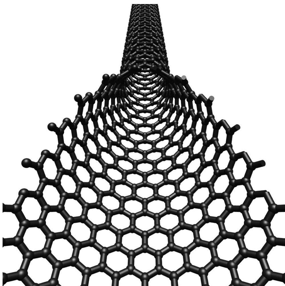
Feuillet de graphène s'enroulant pour former un nanotube de carbone de type zigzag.
