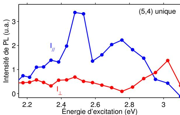
FIGURE 3.30 – Spectre de PLE d'un composé NT/TPP (5,4) unique (intensité de PL intégrée sur  $1,43 \pm 0,01$  eV) pour une excitation parallèle ( $I_{//}$ , bleu) et une excitation perpendiculaire ( $I_{\perp}$ , rouge) à l'axe du nanotube.
