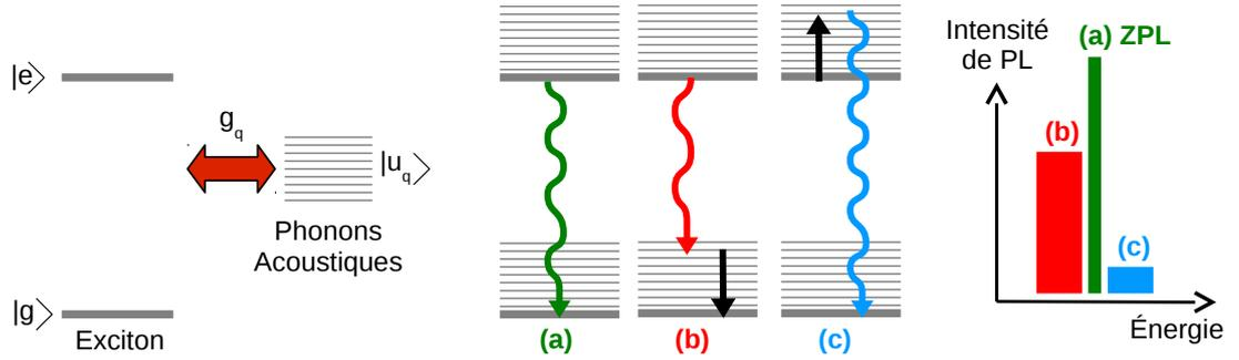
FIGURE 2.16 – Représentation schématique du couplage entre le système excitonique ( $|e\rangle$ ,  $|g\rangle$ ) et les phonons acoustiques ( $|u_q\rangle$ ) produisant des états dits habillés. Les 3 mécanismes d’émission radiative impliquant respectivement (a) aucun, (b) la création, (c) l’annihilation d’un phonon sont responsables des composantes centrale, rouge et bleue du spectre de PL.
