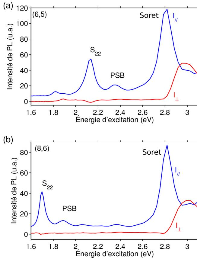
FIGURE 3.28 – Composantes parallèle et perpendiculaire à l’axe du tube extraites d’une expérience de PLE résolue en polarisation sur des composés NT/TPP issus de nanotubes HiPCO (a) (6, 5) et (b) (8, 6).
