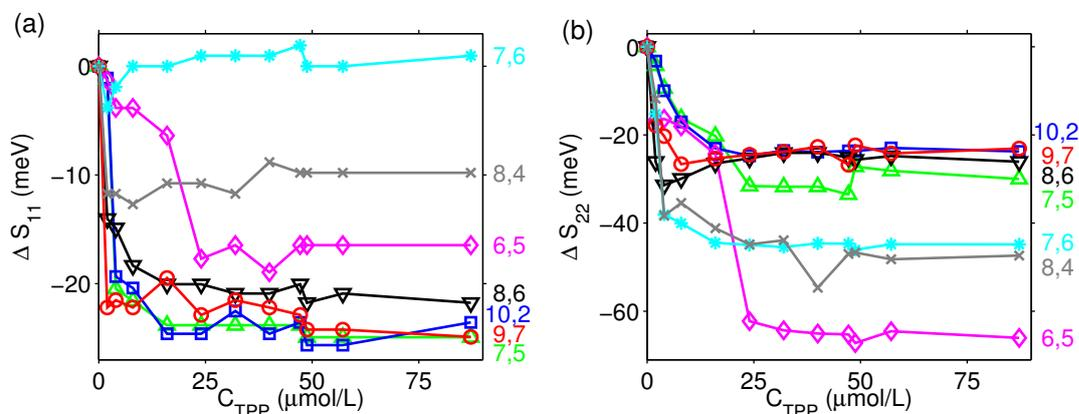
FIGURE 3.14 – Variation des énergies des transitions optiques (a)  $S_{11}$  et (b)  $S_{22}$  en fonction de la concentration initiale de TPP mises en jeu dans la fonctionnalisation, pour une sélection de 7 espèces chirales.
