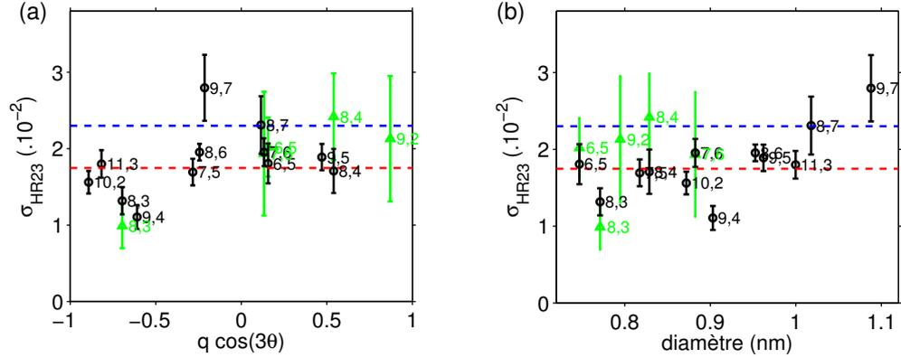
FIGURE 4.21 – Section efficace d’absorption (rapportée à la surface du feuillet de graphène équivalent) évaluée entre les transitions  $S_{22}$  et  $S_{33}$  dans des suspensions de nanotubes HiPCO (cercles noirs) et de CoMoCAT (triangles verts). Les données sont présentées en fonction (a) de l’angle chiral et (b) du diamètre des différentes espèces. Les valeurs moyenne (rouge) et de référence du graphène (bleu) sont indiquées.
