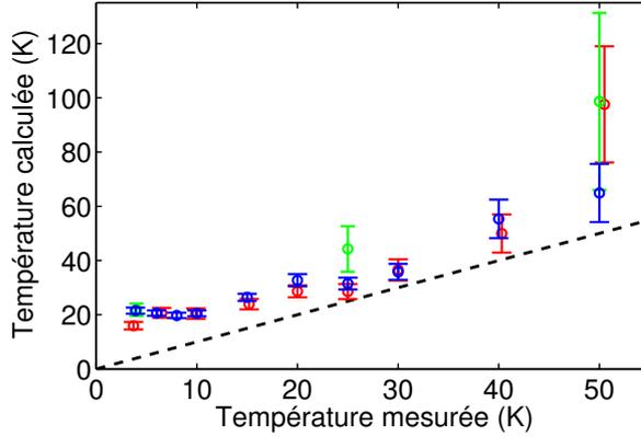
FIGURE 2.17 – Évolution en fonction de la température expérimentalement mesurée d’une température effective extraite des spectres (selon le code couleur adopté en Figure 2.14) en introduisant une loi de Boltzmann régissant les amplitudes relatives des ailes :  $T_{eff} = \epsilon/k_B \ln(I_{-\epsilon}/I_{+\epsilon})$ , avec  $\epsilon = 2,3$  meV.
