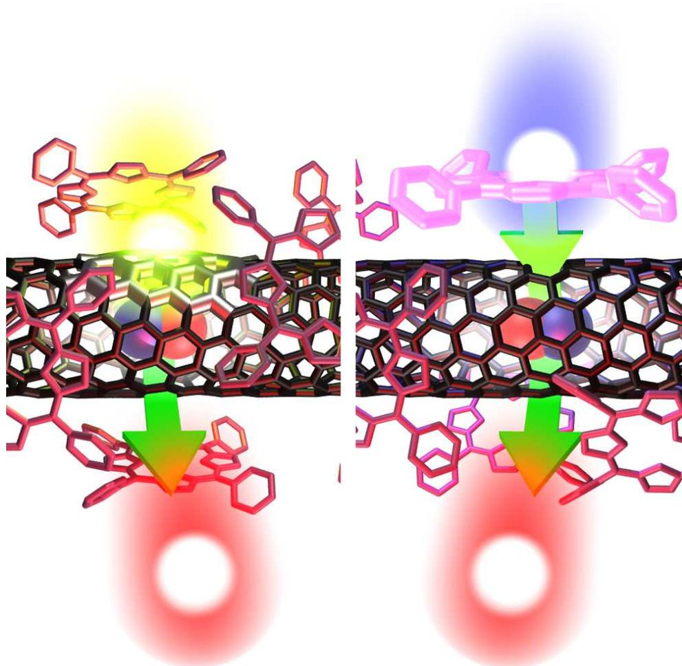
Deux processus de photoluminescence dans les nanotubes fonctionnalisés mettant en jeu l'absorption intrinsèque du tube (gauche) ou l'absorption d'une molécule et un transfert d'énergie (droite).
