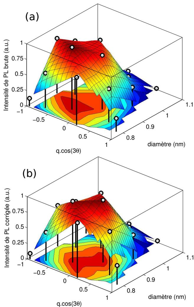
FIGURE 4.11 – (a) Intensité brute normalisée de PL, avec une excitation à  $S_{22}$ , extraite pour 15 espèces chirales (cercles noirs) présentes dans une solution HiPCO, en fonction du diamètre et de  $q \cos(3\theta)$ . Une enveloppe d'interpolation linéaire des valeurs a été ajoutée dans une meilleure visualisation des variations relatives. (b) Mêmes données corrigées par les variations d'absorption entre espèces chirales.
