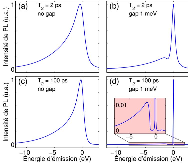
FIGURE 2.22 – Spectres de PL évalués numériquement en variant le temps de cohérence  $T_2 = 2$  ps (a,b) ou 100 ps (c,d) ainsi que la présence d'une annulation du facteur de forme pour les basses énergies ( $< \hbar\omega_c = 1$  meV). Les autres paramètres sont inchangés, tels que  $T = 5$  K,  $D = 13$  eV et  $\sigma = 3$  nm.
