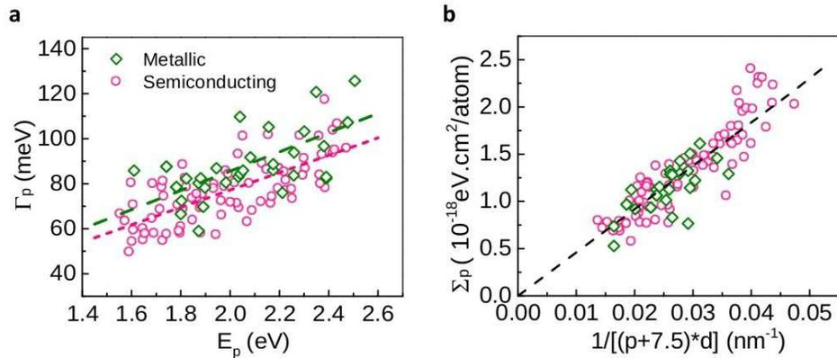
FIGURE 4.2 – (a) Largeur des transitions optiques  $\Gamma_p$  en fonction de l'énergie de la transition  $E_p$ . (b) Force d'oscillateur de la transition  $\Sigma_p$  en fonction du diamètre  $d$  de l'espèce et de l'indice  $p$  de la transition (paragraphe 1.1.3). Les mesures sont effectuées sur nanotubes uniques. Extraits de [151].
