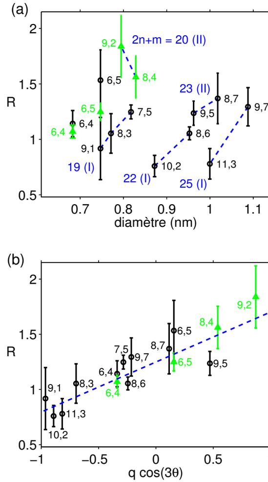
FIGURE 4.9 – (a)  $R$  en fonction du diamètre. Les tubes sont reliés par un trait discontinu selon leur famille, dont la valeur  $(2n + m)$  et le type (I ou II) sont indiqués. (b)  $R$  en fonction du paramètre géométrique  $q \cos(3\theta)$ . Trait discontinu : ajustement linéaire des points expérimentaux.
