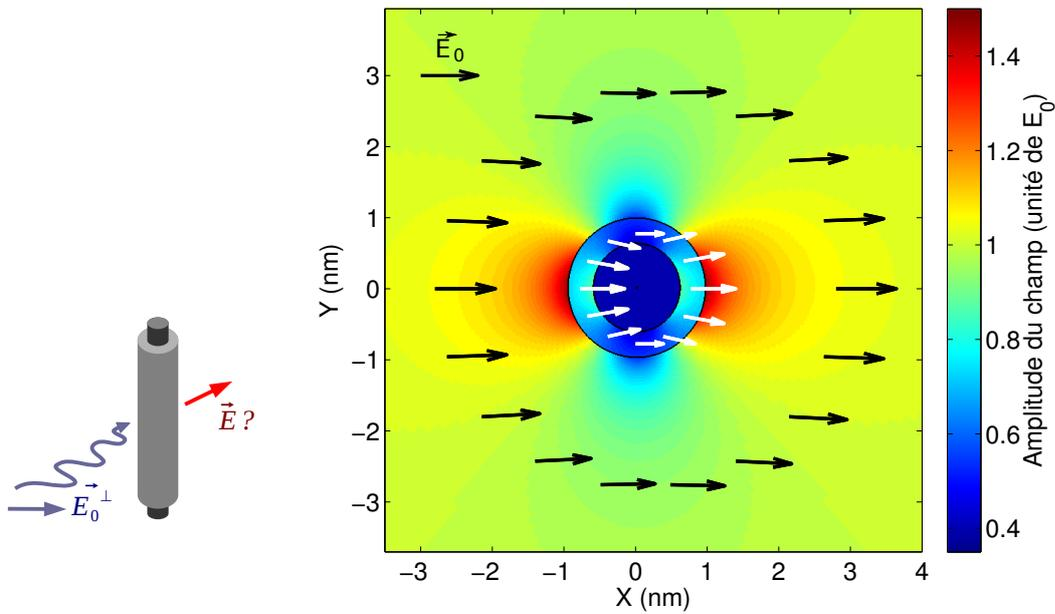
FIGURE 3.33 – Amplitude du champ local pour un champ incident orthogonal à l'axe du nanotube. Les vecteurs champ sont tracés pour une distance par rapport à l'axe central (blanc)  $r = 0,775$  nm et (noir)  $r = 2,8$  nm.
