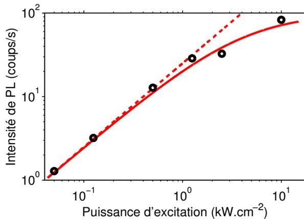
FIGURE 2.3 – Évolution typique de l'intensité de PL d'un nanotube en fonction de la puissance d'excitation, pour une température  $T = 10$  K. La courbe rouge est un guide pour les yeux mettant en évidence la saturation et l'écart à une loi linéaire (trait discontinu)
