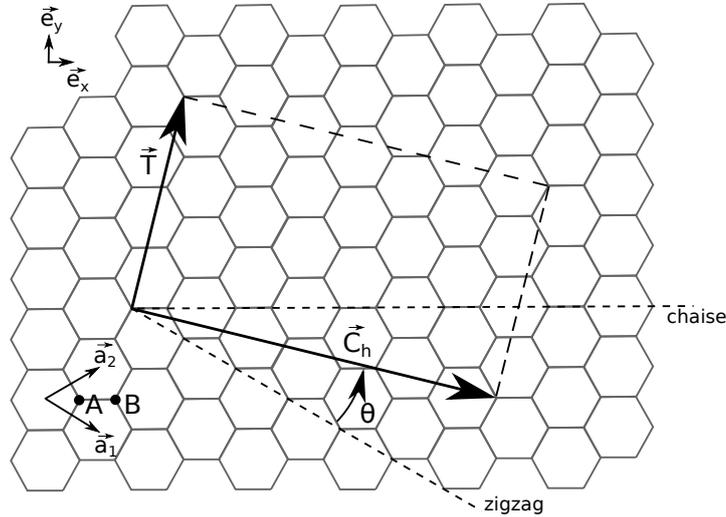
FIGURE 1.2 – Construction d'un nanotube monoparoï de chiralité  $(n, m) \equiv (5, 2)$  à partir d'une feuille de graphène. Le vecteur chiral  $\vec{C}_h = n\vec{a}_1 + m\vec{a}_2$  définit totalement la géométrie du tube.
