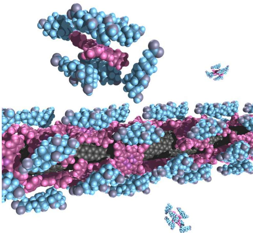
Nanotube de carbone fonctionnalisé par des molécules de porphyrine dans un solution aqueuse micellaire de cholate de sodium.
