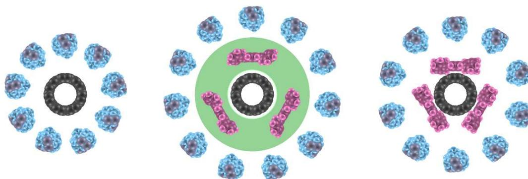
FIGURE 3.6 – Représentation schématique des étapes de la méthode de gonflement de la micelle. Dans une solution micellaire (cholate, bleu) de nanotubes de carbone (noir), le DCM (vert) est utilisé comme vecteur pour apporter les molécules de TPP (rose) au plus près des tubes avant de s'évaporer.
