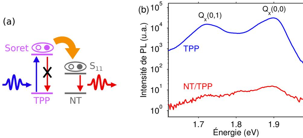
FIGURE 3.10 – (a) Schéma du processus de PL des nanotubes avec excitation sur la bande de Soret des TPP, impliquant un transfert d'énergie et une extinction de la PL des TPP. (b) Intensité de PL des bandes  $Q_x$  des TPP, avec excitation en résonance avec la bande de Soret, mesurée pour des solutions de TPP en micelles (TPP libres, bleu) et de composés NT/TPP HiPCO (TPP liées, rouge).
