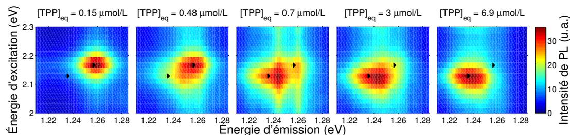
FIGURE 3.19 – Cartes de PLE pour des solutions présentant différentes concentrations  $[TPP]_{eq}$  de TPP à l'équilibre, centrées sur le couple d'énergie  $(S_{11}, S_{22})$  de l'espèce (6, 5). La transition d'une couverture nulle à une couverture totale est mise en évidence par le décalage spectral vers le rouge, les deux positions extrémales du maximum d'intensité étant indiquées.
