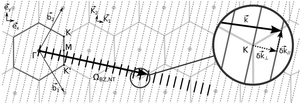
FIGURE 1.4 – Espace réciproque du graphène défini par les vecteurs  $(\vec{b}_1, \vec{b}_2)$ . La quantification le long de la circonférence du nanotube entraîne une restriction de cet espace pour les nanotubes de carbone. L'espace réciproque d'un nanotube  $(5, 2)$  est représenté en lignes pointillées, la première zone de Brillouin étant en trait plein. Tout vecteur de cet espace se décompose ainsi en deux composantes  $\vec{k} = \vec{k}_F + \delta\vec{k}_\perp + \delta\vec{k}_\parallel$ .
