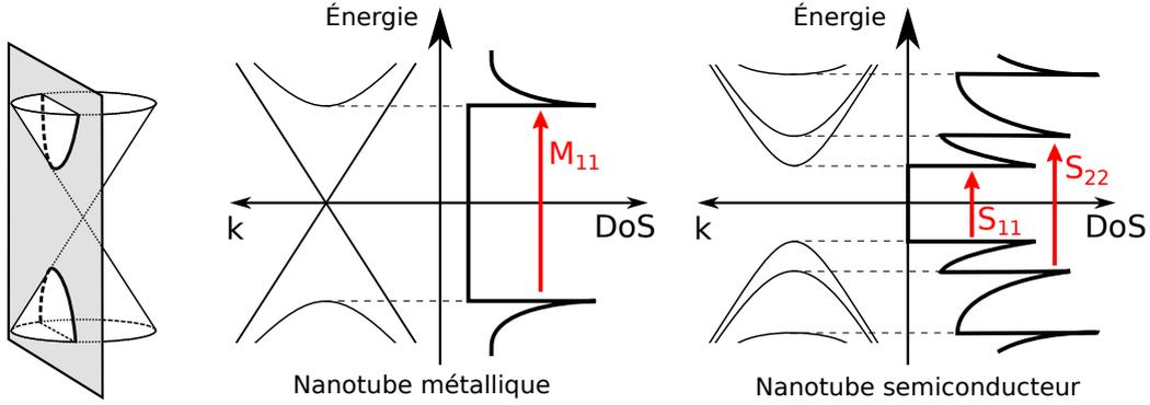
FIGURE 1.6 – Dispersion et densité d'états de nanotubes métallique ou semiconducteur, obtenues en effectuant des coupes parallèles dans la dispersion du graphène. Les premières transitions optiques  $M_{ii}$  et  $S_{ii}$  permises pour une polarisation parallèle à l'axe du nanotube sont notées.
