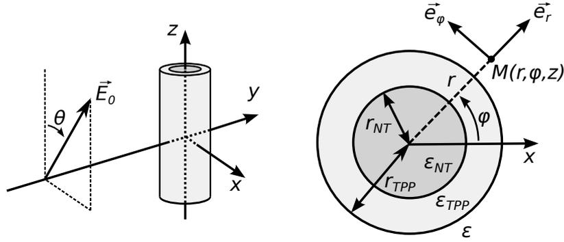
FIGURE 3.32 – Modélisation d'un composé NT/TPP à l'aide d'un cylindre diélectrique ( $\epsilon_{NT}, r_{NT}$ ) infini, entouré d'une coquille ( $\epsilon_{TPP}, r_{TPP}$ ) et plongé dans un milieu homogène ( $\epsilon$ ). L'effet de champ local au point  $M(r, \varphi, z)$  est calculé en fixant le champ lointain  $\vec{E}_0$ .
