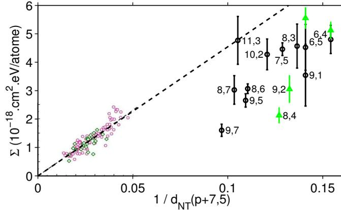
FIGURE 4.16 – Force d'oscillateur des résonances optiques en fonction de  $1/d_{NT}(p+7,5)$ , pour nos données expérimentales (HiPCO en cercle noir, CoMoCAT en triangle vert) et les valeurs issues de [151].
