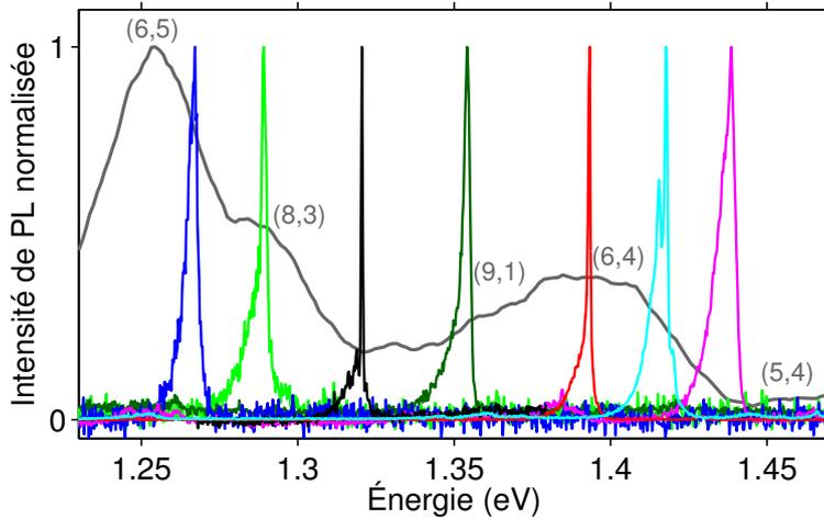
FIGURE 2.1 – Spectres normalisés de PL de 7 nanotubes uniques différents à température cryogénique ( $T < 10$  K). (gris) Spectre normalisé de PL d'un ensemble macroscopique de nanotubes en matrice ( $T = 300$  K). Les contributions des différentes espèces chirales sont indiquées.
