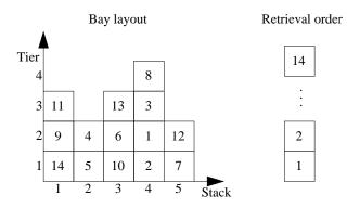
Figure A.7: Problème de repositionnement de conteneurs
