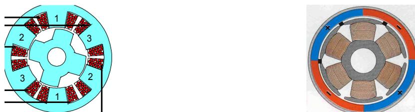
a- Structure triphasée 6-4 à réluctance variable à double saillance, b- structure triphasée 2 paires de pôles, à aimants permanents et induit à pôles saillants .
