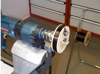
Fig. 4.12 a-Réalisation d'un bobinage de puissance
