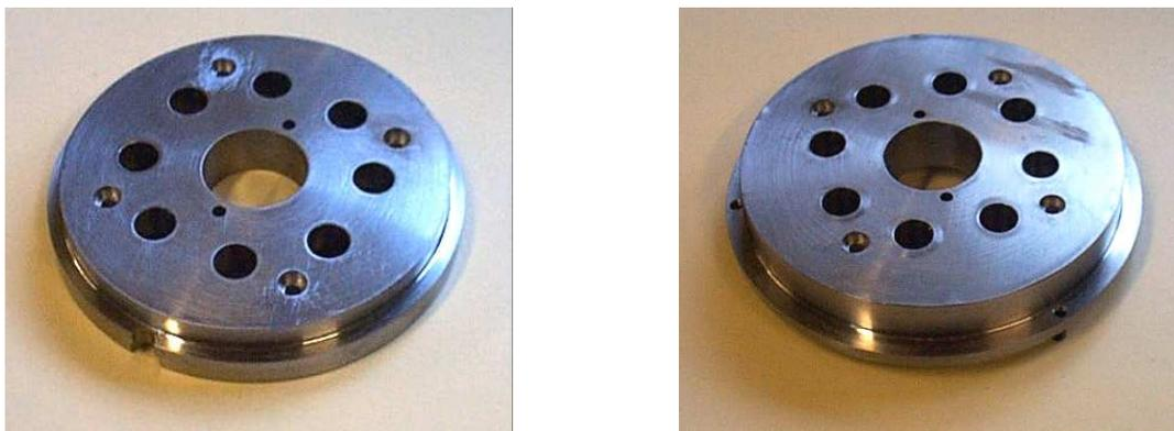
Fig. 4.6 b-Extrémités de la culasse de l'actionneur
