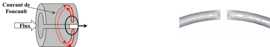
Fig. 4.36 b-Courants de Foucault dans un cylindre fendu
