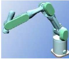
Fig 4.37 a-Exemple de robot série
